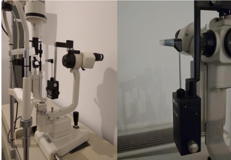
Figura 36. LH modelo Topcon SL/3FD (imagen de la izquierda). Tonómetro modelo Haag-Streit AT900 (imagen de la derecha). Imagen de elaboración propia.
