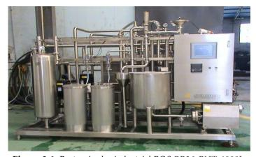
Figura 3.6. Pasteurizador industrial EQS BR26-PUT-4000L.
