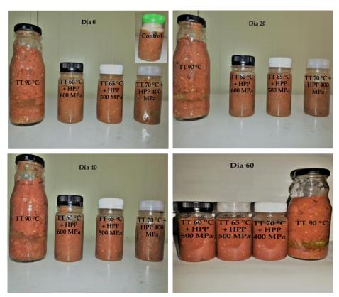
**Figura 3.2.** Evolución durante el almacenamiento de los envases con el puré de tomate (ajustado a pH 3,8) tratado según los tratamientos empleados en el **Apartado 4.2**.
