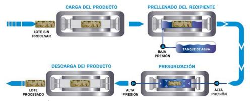
**Figura 1.14.** *Esquema del tratamiento de muestras por HPP* (www.hiperbaric.com/es/aplicaciones).
