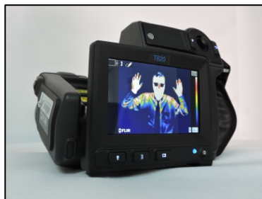
Figura 8. Cámara de infrarrojos (modelo T620/ Serial 55905781 (FLIR®Systems, Sweden)
