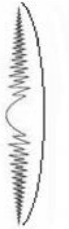
Figura 31. Escalones de una LIO trifocal difractiva.
