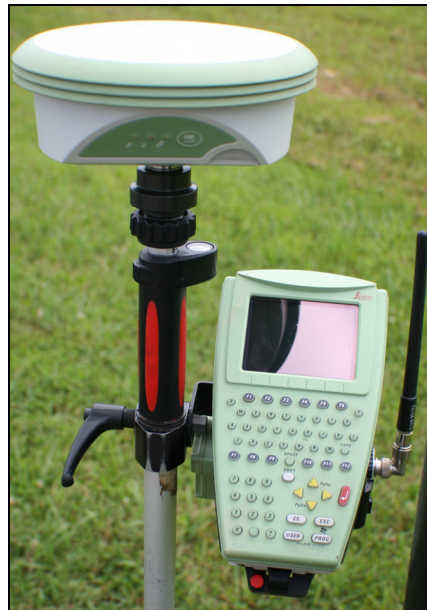
Figura 62. GPS LEICA 1200 con antena ATX1230GG (Fuente: Leica).
