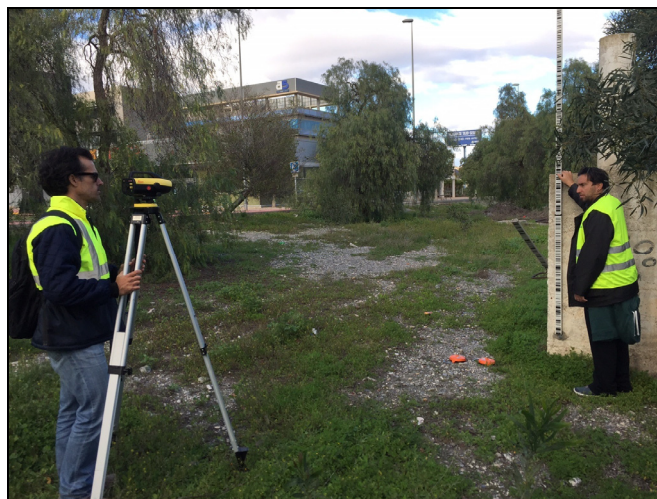
Figura 57. Fotografía de una observación mediante nivelación geométrica (Fuente: Elaboración propia).
