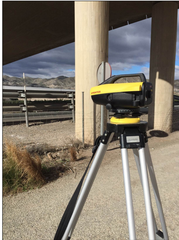
Figura 56. Fotografía del nivel SPRINTER 100 utilizado (Fuente: Elaboración propia).
