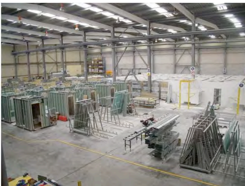
Figura 2.4.- Producción de módulos de baños prefabricados. Conspace, año 2015
