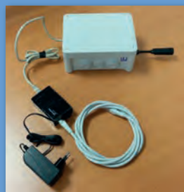
Arriba, conjunto de caja estanca con micrófono y alimentación eléctrica y conectividad de datos a través de dispositivo POE (Power Over Ethernet)
