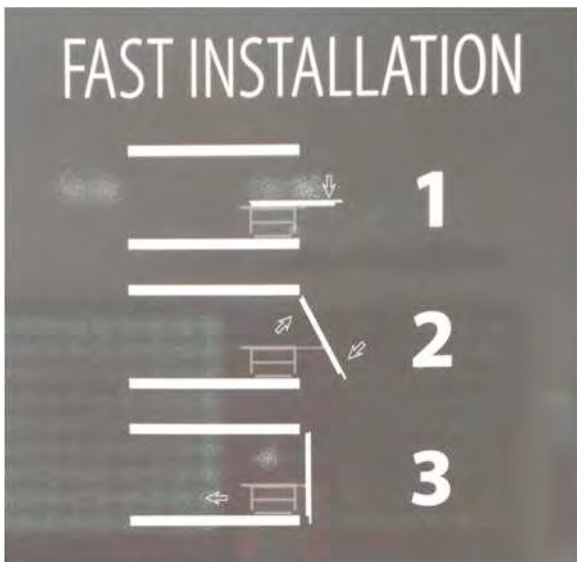
Figura 3.4.- Instalación del sistema modular de fachada. Butech, Porcelanosa Grupo, año 2016
