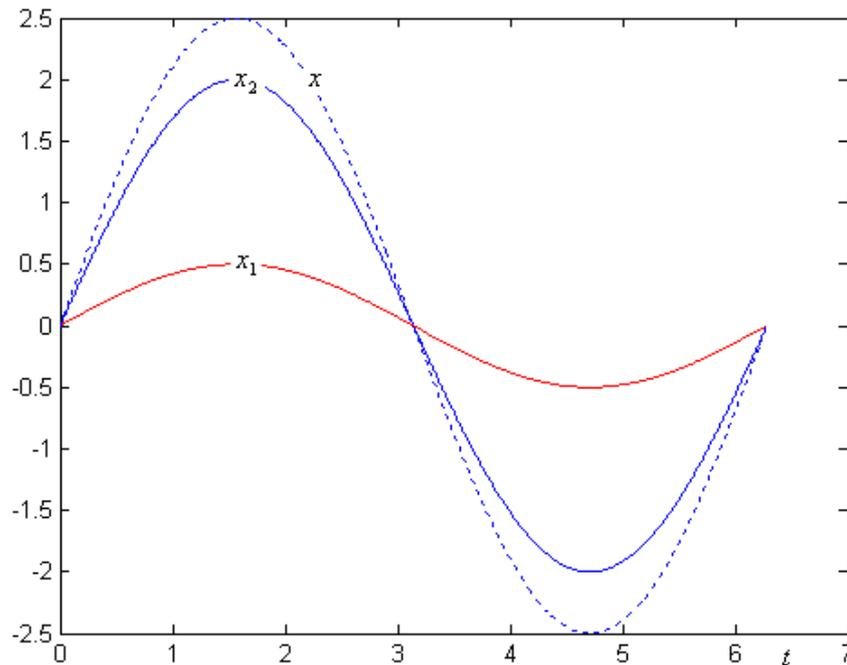
**Ejercicio 1.4.** Calcular la diferencia de fase que deben tener dos movimientos vibratorios armónicos del mismo periodo, dirección y amplitud, para que el movimiento resultante tenga la misma amplitud que cualquiera de ellos, y expresar la ecuación del movimiento resultante.
