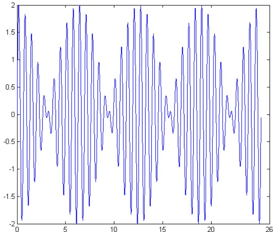
Suponiendo un muelle sometido a los dos movimientos, el resultado sería una oscilación rápida de frecuencia  $(w_1 + w_2)/2$ , con amplitud variable oscilando con frecuencia  $(w_1 - w_2)/2$ . A la frecuencia menor (periodo mayor) se le denomina frecuencia de pulsación.
