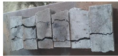
Figura 1.36 Planos de rotura en las probetas ensayadas. Fuente: Elaboración propia.
