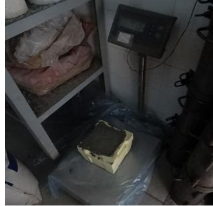
Figura 1.54 Pesaje de probeta en estado fresco para obtención de densidad. Fuente: Elaboración propia.
