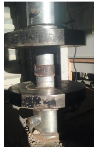
Figura 1.42 Ensayo de resistencia a compresión confinada, con anillo de guarda al centro. Fuente: Elaboración propia.
