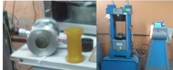
Figura 1.67 Celda para ensayo triaxial (izquierda) y prensa triaxial (derecha). Fuente: Elaboración propia.
