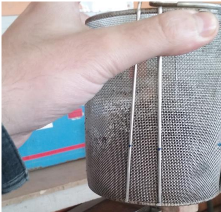
Figura 1.64 Determinación de la pérdida por lavado. Fuente: Elaboración propia.
