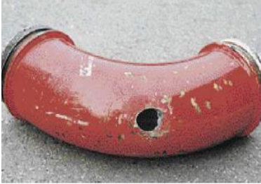
Figura 1.5 Codo de tubería roto debido a cizallamiento.
