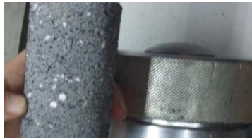
Figura 1.66 Testigo ensayado en prensa triaxial. Fuente: Elaboración propia.
