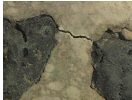
Figura 1.20 Microfisura entre partículas de NFU. Fuente [35].
