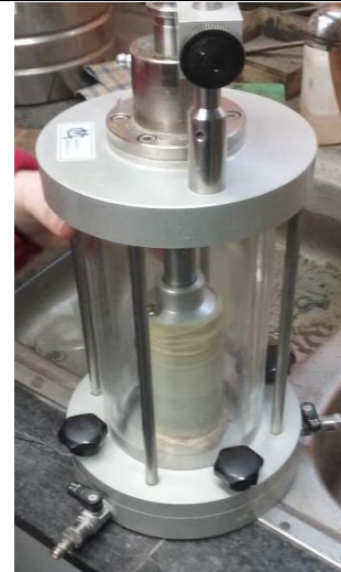
Figura 1.59 Celda para el sistema automático de 4 presiones de determinación de la permeabilidad. Fuente: Elaboración propia.
