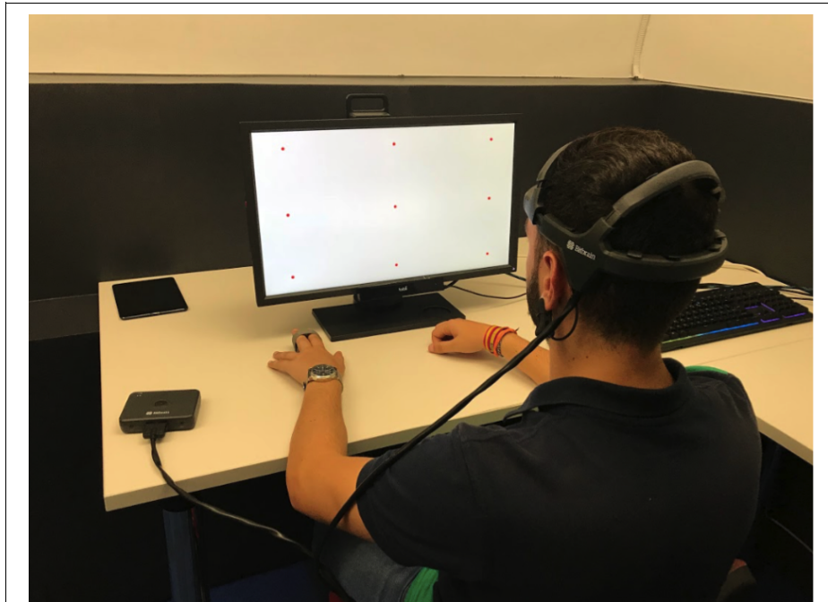
Figura 35. Comprobación de calibración correcta de Eye Tracker – Tobii Pro X2-30 en software SennsLab. Fuente: Elaboración propia.
