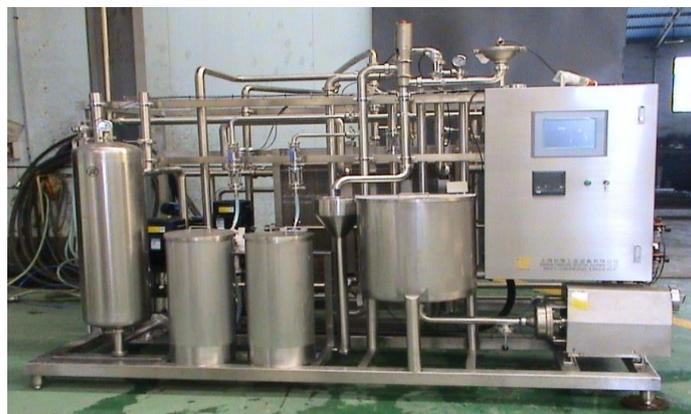
**Figura 3.6.** *Pasteurizador industrial EQS BR26-PUT-4000L.*
