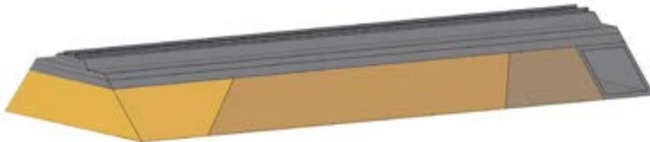
Figura 4.2.32 Esquema de obra de fábrica enterrada superficial ( $H=0,4$  m), cuña granular. Fuente: Elaboración propia.
