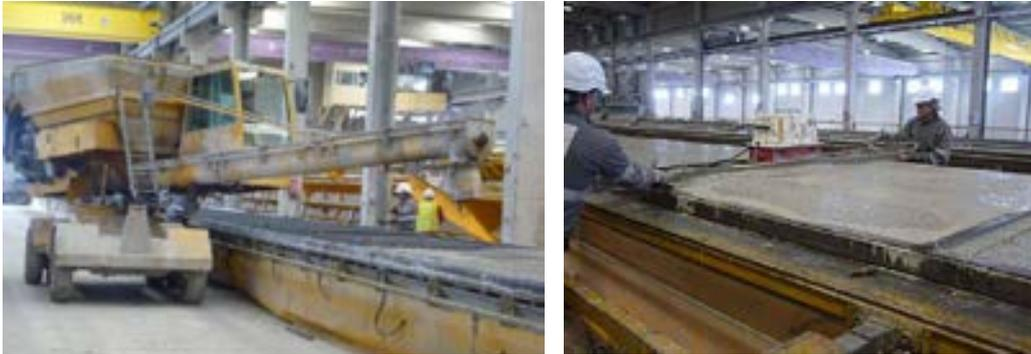
Figura 5.1.2 Imagen vertido hormigón fresco. Fuente: Elaboración propia.
