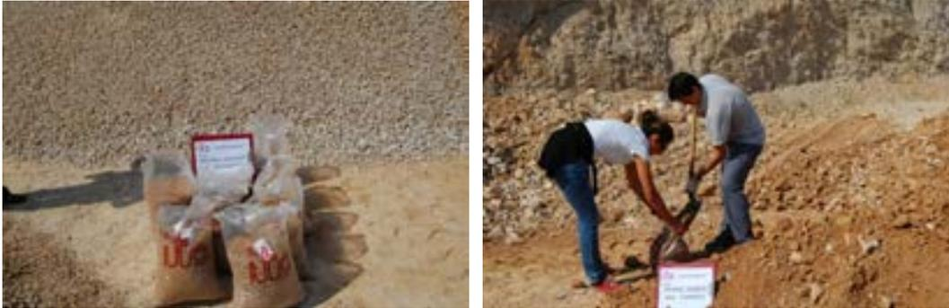
Figura 5.1.7 Imagen material granular de machaqueo (izquierda) y de terraplén (derecha). Fuente: ITC.
