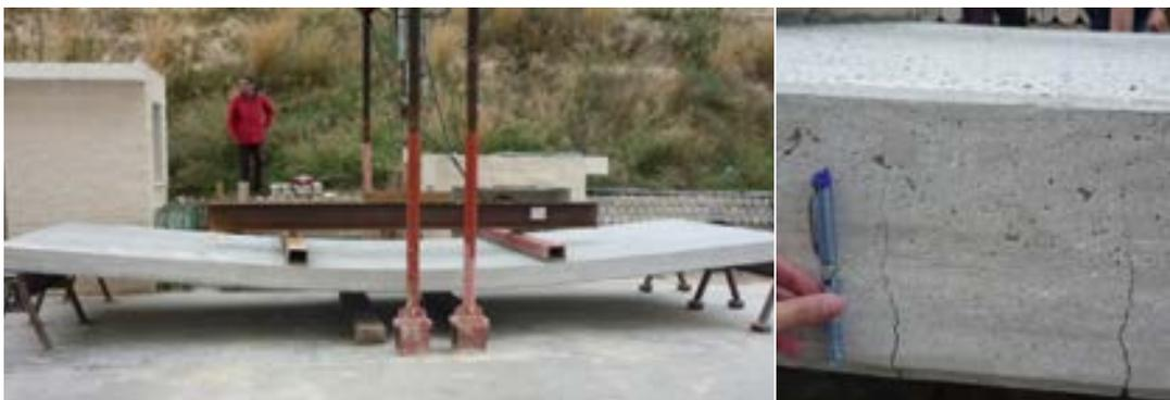
Figura 5.1.9 Imágenes del ensayo a flexión en la losa. Fuente: elaboración propia.
