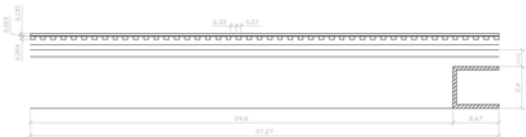
Figura 4.2.11 Dimensiones en el eje Z del modelo de obra de fábrica enterrada semi-profunda (H=1 m). Fuente: Elaboración propia.
