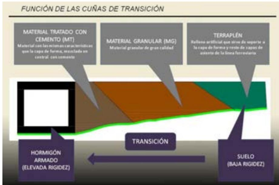
Figura 3.2.1. Esquema funcionamiento de las cuñas de transición tradicionales. Fuente: [48]
