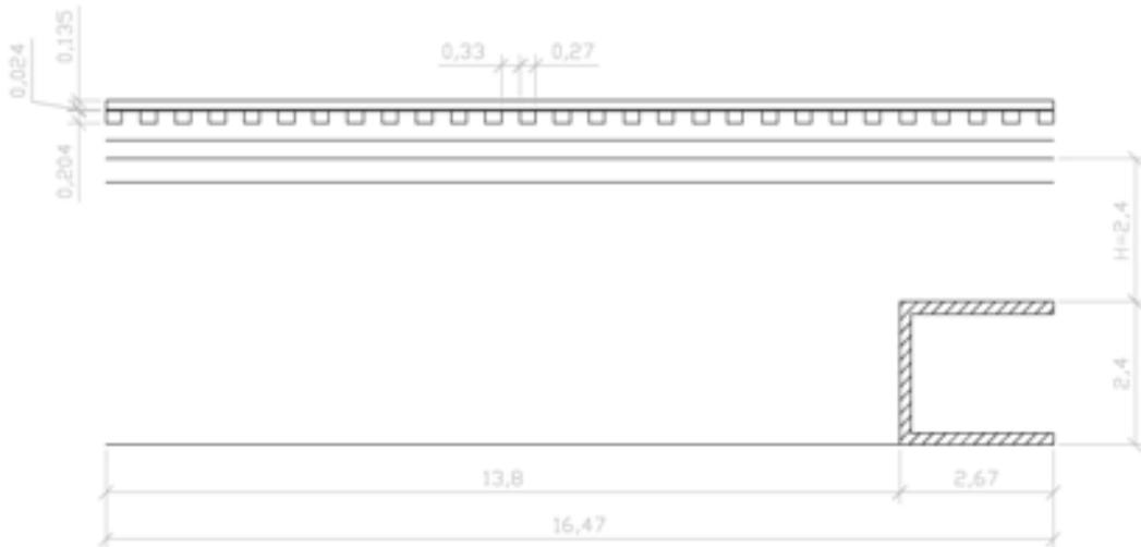
Figura 4.2.9. Dimensiones en el eje Z del modelo de obra de fábrica enterrada profunda (H=2,4 m). Fuente: Elaboración propia.
