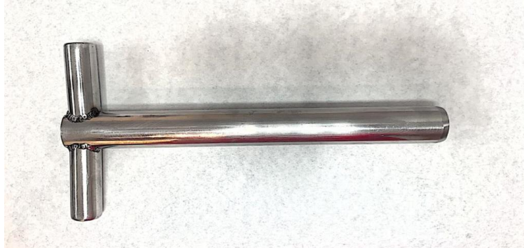
Figura III.6. Detalle del instrumento "sacabocados" (Fte. Elaboración propia).
