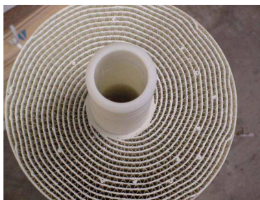
Figura 23. Detalle de la membrana de ultrafiltración empleada, donde se pueden observar las capas del espaciador de agua de alimentación y el espaciador del canal de permeado, que forman un conjunto de múltiples hojas enrolladas en torno al tubo de permeado.
