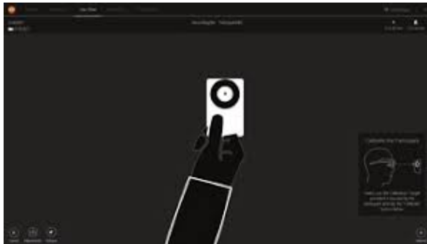
Figura 8. Proceso de calibración de las gafas Tobii Pro Glasses 2 Versión 1.1.3. con el software "Tobii Pro Glasses Controller". Tomado de Tobii Pro Glasses 2 (s.f.)
