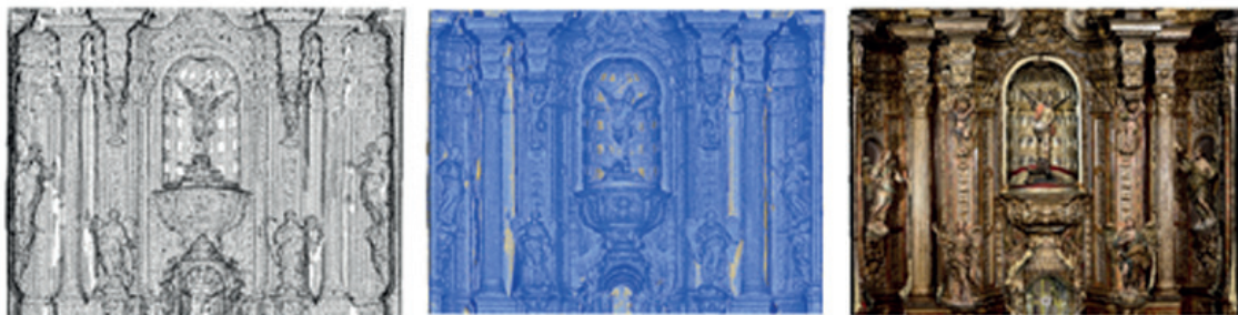
Ilustración 2. Nube de puntos, malla de triángulos y textura del cuerpo principal del retablo de San Miguel de Murcia (de izquierda a derecha) (Fuente: Elaboración propia).
