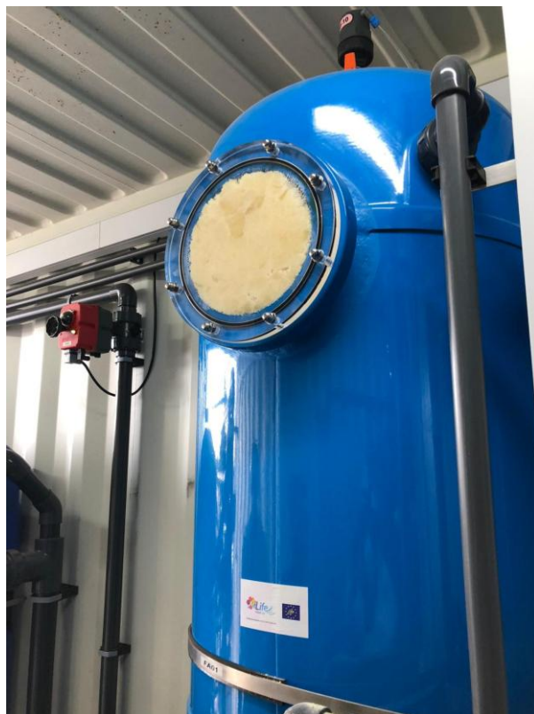
Figura V.50 . Imagen de la torre de adsorción 1, donde podemos observar la elevada capacidad de hinchamiento del polímero al ponerlo en contacto con el influente, en los ensayos de validación funcional del piloto semiindustrial.
