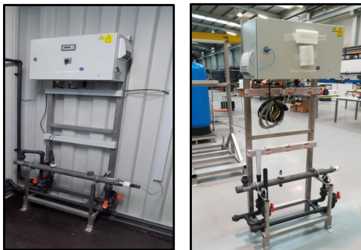
Figura IV.16 Marco/montaje de la unidad de fotocátalisis.
