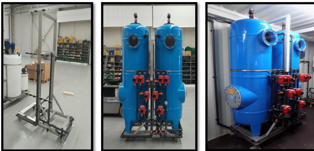
Figura IV.15 Marco/montaje de la unidad de adsorción.
