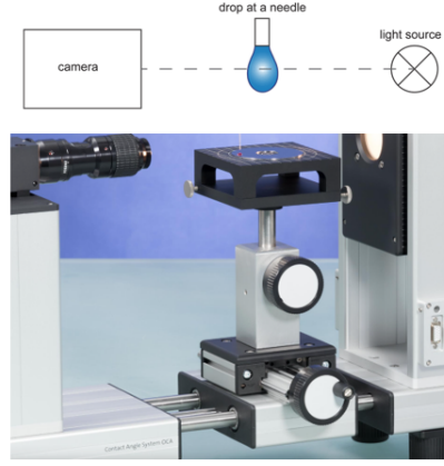
Figura 3.9: Configuración esquemática del equipo de medida para el Pendant drop method . Fuente: Referencia [113]
