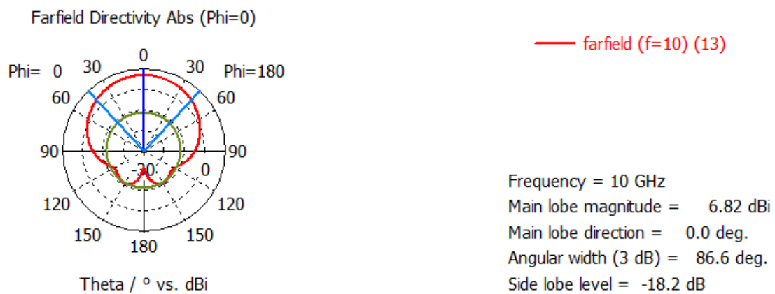
Figura 35. Patrón de radiación bidimensional (Plano E, Phi=0) de la antena parche optimizada a 10 GHz.
