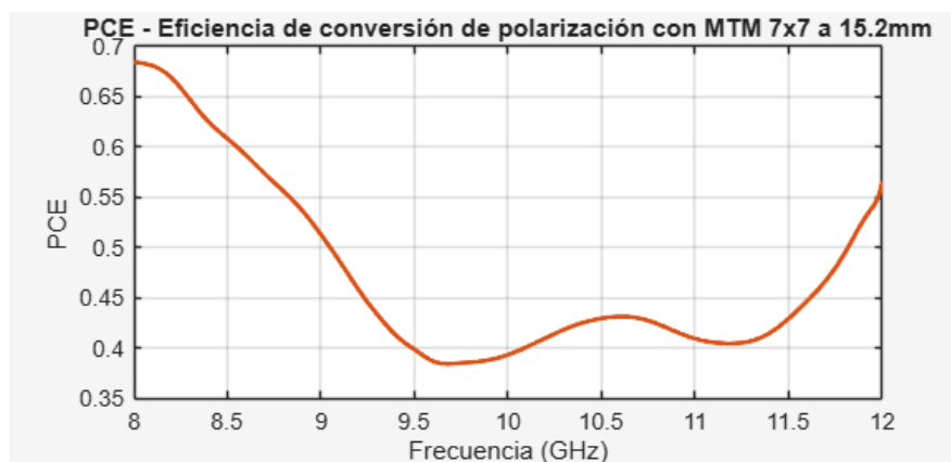
Figura 81. Eficiencia de conversión de polarización (PCE) para la configuración de metamaterial de 7x7 a 15.2 mm.
