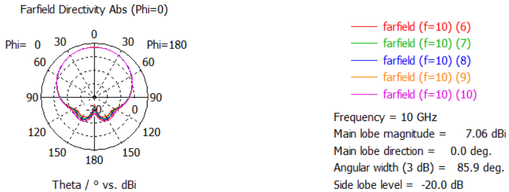
Figura 30. Diagramas de radiación en campo lejano (Plano E, Phi=0) para el barrido paramétrico de L_{pc} a la frecuencia de diseño de 10 GHz.
