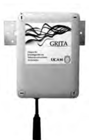
Figura 6. Diseño final del sensor acústico encapsulado en caja estanca para su instalación en exteriores.
