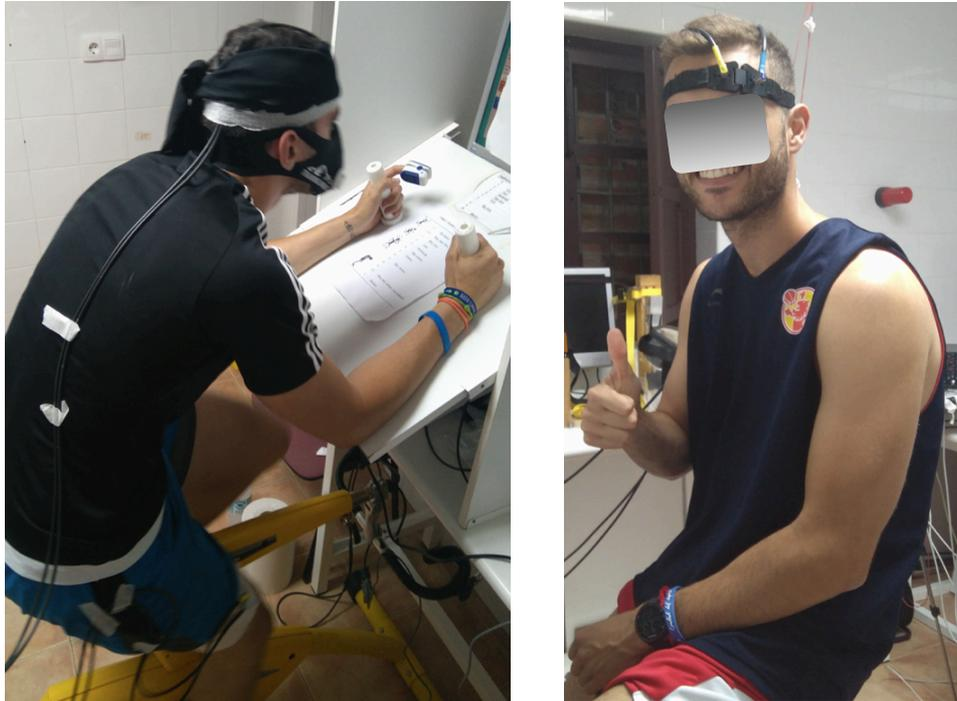
Figura 16: colocación de optodos en el vasto lateral y en la corteza prefrontal.
