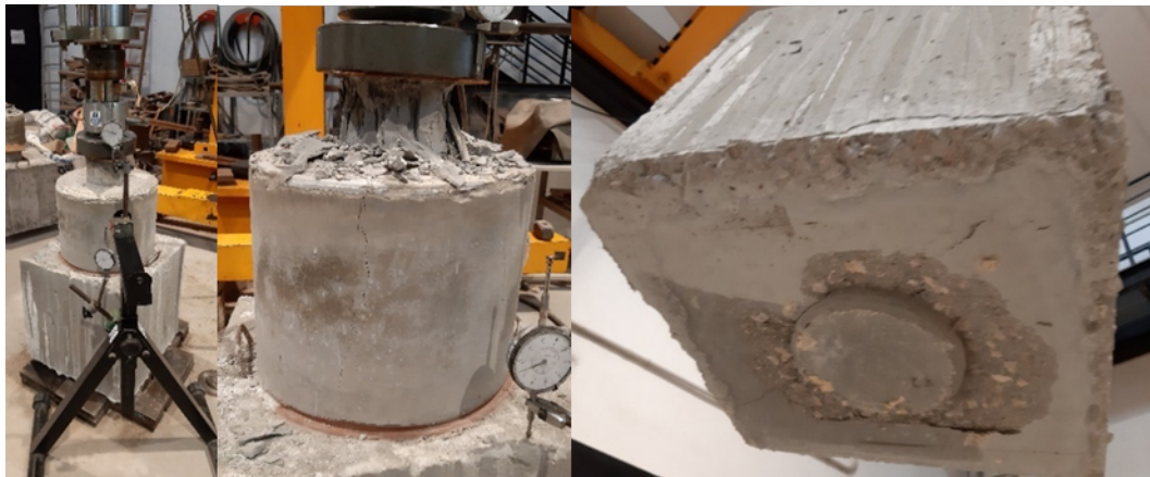
Figura 107. Fotografías de la probeta S15 antes y después de la rotura. Fuente: Elaboración propia.
