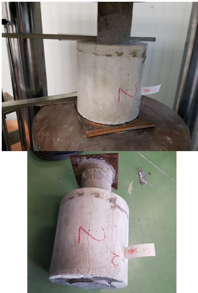
Figura 76. Fotografías de la probeta Cilíndrica 2 antes y después de la rotura. Fuente: Elaboración propia.
