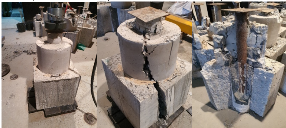
Figura 139. Fotografías de la probeta SA16 antes y después de la rotura. Fuente: Elaboración propia.
