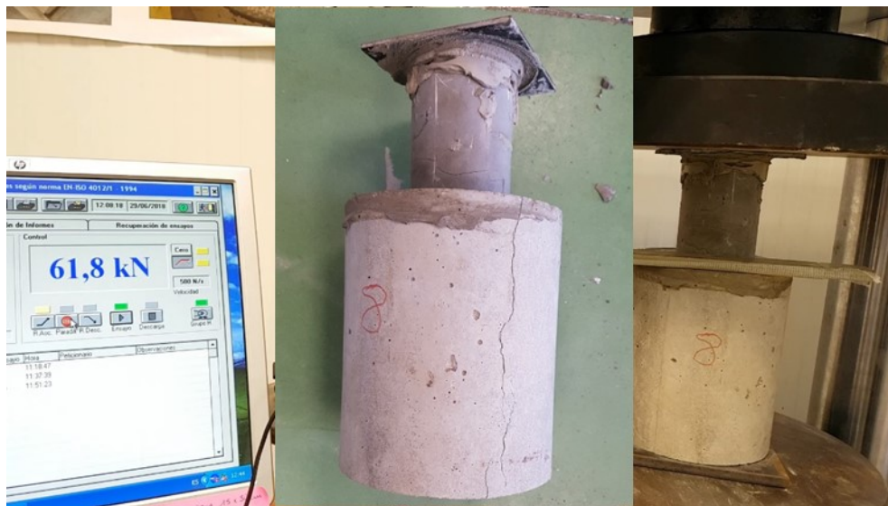
Figura 78. Fotografías de la probeta Cilíndrica 8 antes y después de la rotura. Fuente: Elaboración propia.
