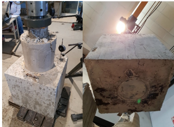
Figura 135. Fotografías de la probeta SA14 antes y después de la rotura. Fuente: Elaboración propia.
