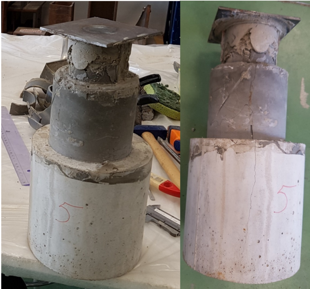
Figura 143. Fotografías de la probeta Cilíndrica 5 antes y después de la rotura. Fuente: Elaboración propia.
