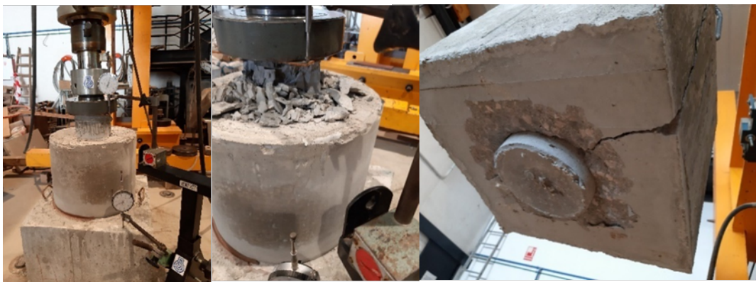
Figura 109. Fotografías de la probeta S16 antes y después de la rotura. Fuente: Elaboración propia.
