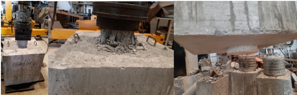
Figura 59. Fotografías de la probeta C1 antes y después de la rotura. Fuente: Elaboración propia.
