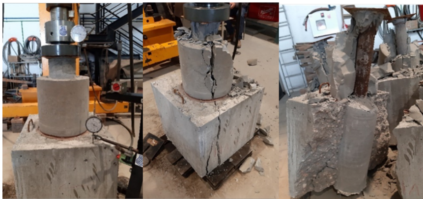
Figura 105. Fotografías de la probeta S14 antes y después de la rotura. Fuente: Elaboración propia.
