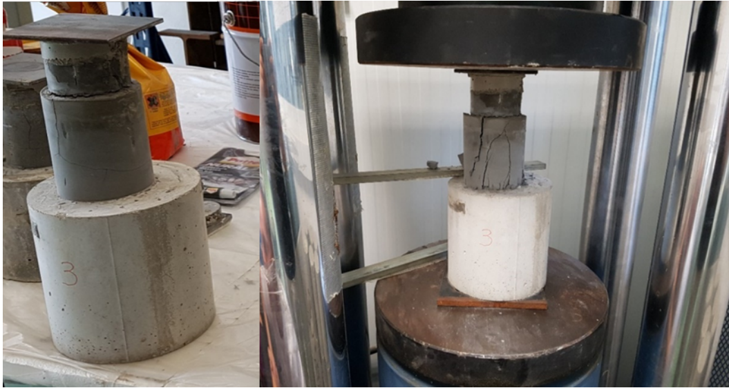
Figura 141. Fotografías de la probeta Cilíndrica 3 antes y después de la rotura. Fuente: Elaboración propia.
