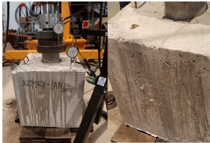
Figura 69. Fotografías de la probeta C6 antes y después de la rotura. Fuente: Elaboración propia.
