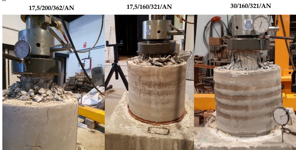
Figura 47. Probetas llevadas a rotura en pórtico que han desarrollado una rotura en la zona de la cabeza del micropilote. Fuente: Elaboración propia.
