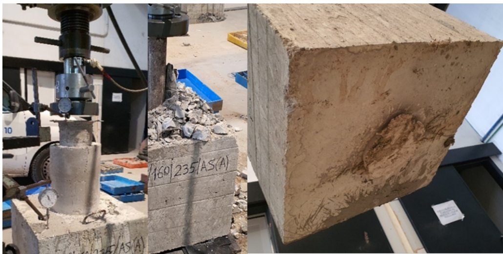
Figura 111. Fotografías de la probeta SA1 antes y después de la rotura. Fuente: Elaboración propia.
