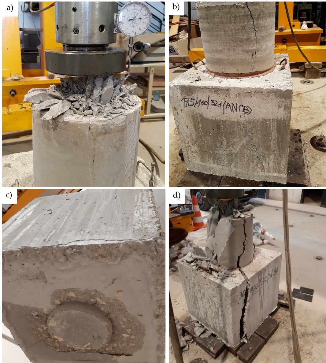
Figura 24. Fotografías de roturas en los ensayos de la conexión con sombrero sin armadura: a) rotura de la cabeza del micropilote; b) deslizamiento del micropilote; c) fisuras en la zapata; d) rotura monolítica de la zapata. Fuente: Elaboración propia.
