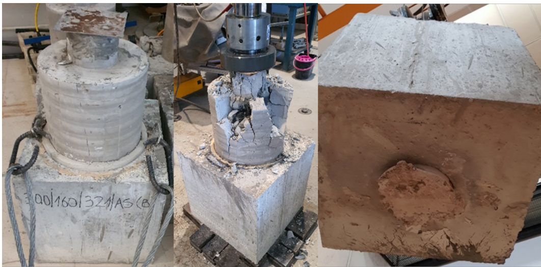
Figura 117. Fotografías de la probeta SA4 antes y después de la rotura. Fuente: Elaboración propia.
