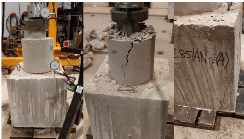
Figura 103. Fotografías de la probeta S13 antes y después de la rotura. Fuente: Elaboración propia.
