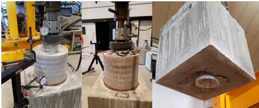
Figura 83. Fotografías de la probeta S3 antes y después de la rotura. Fuente: Elaboración propia.
