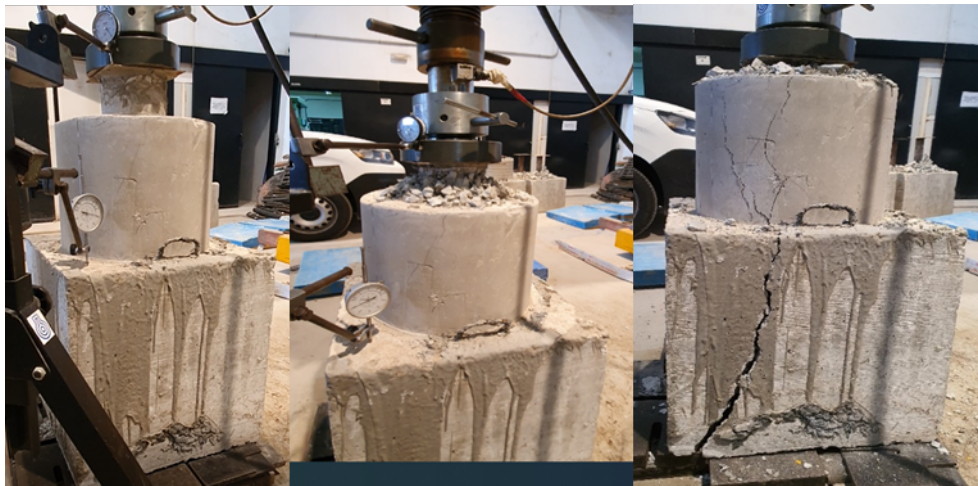
Figura 122. Fotografías de la probeta SA7 antes y después de la rotura. Fuente: Elaboración propia.
