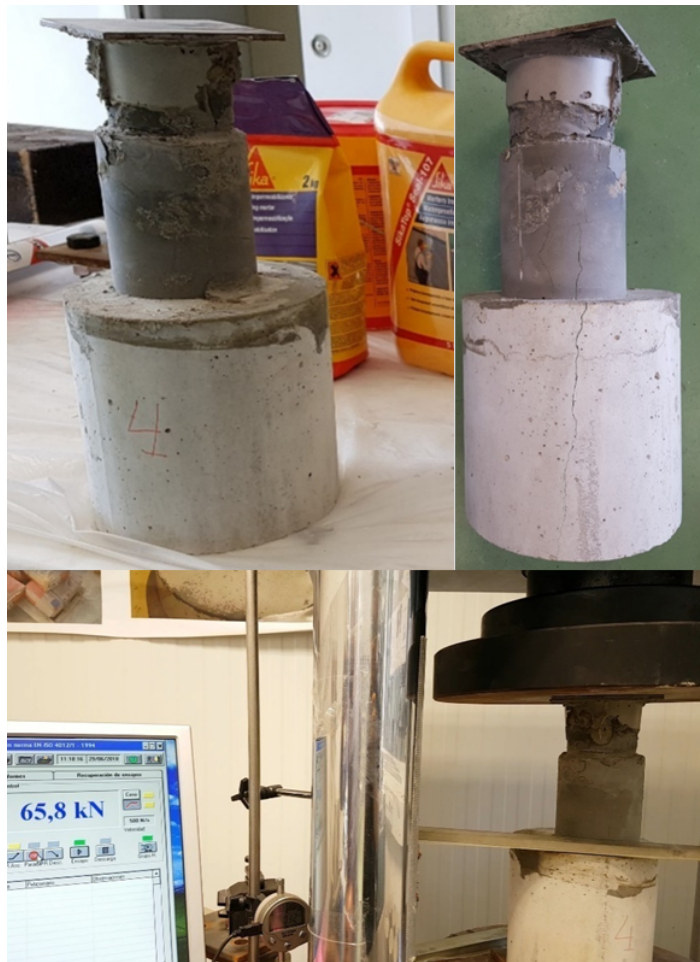
Figura 142. Fotografías de la probeta Cilíndrica 4 antes y después de la rotura. Fuente: Elaboración propia.
