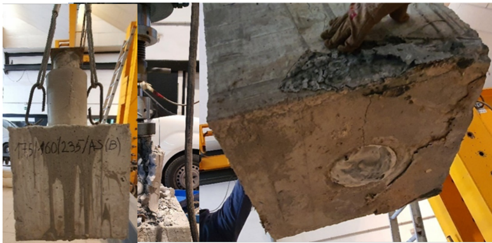
Figura 126. Fotografías de la probeta SA9 antes y después de la rotura. Fuente: Elaboración propia.
