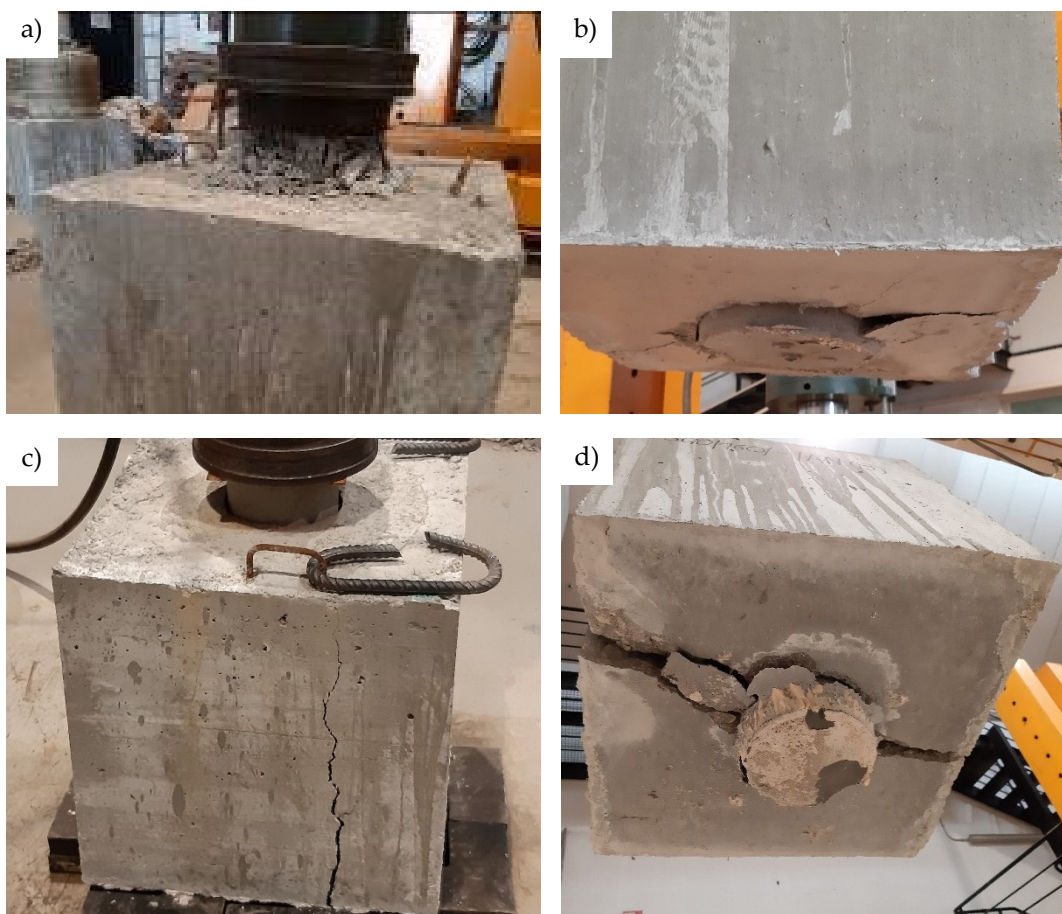
Figura 23. Fotografías de roturas en los ensayos de la conexión convencional: a) rotura de la cabeza del micropilote; b) deslizamiento del micropilote; c) fisuras en la zapata; d) rotura monolítica de la zapata. Fuente: Elaboración propia.
