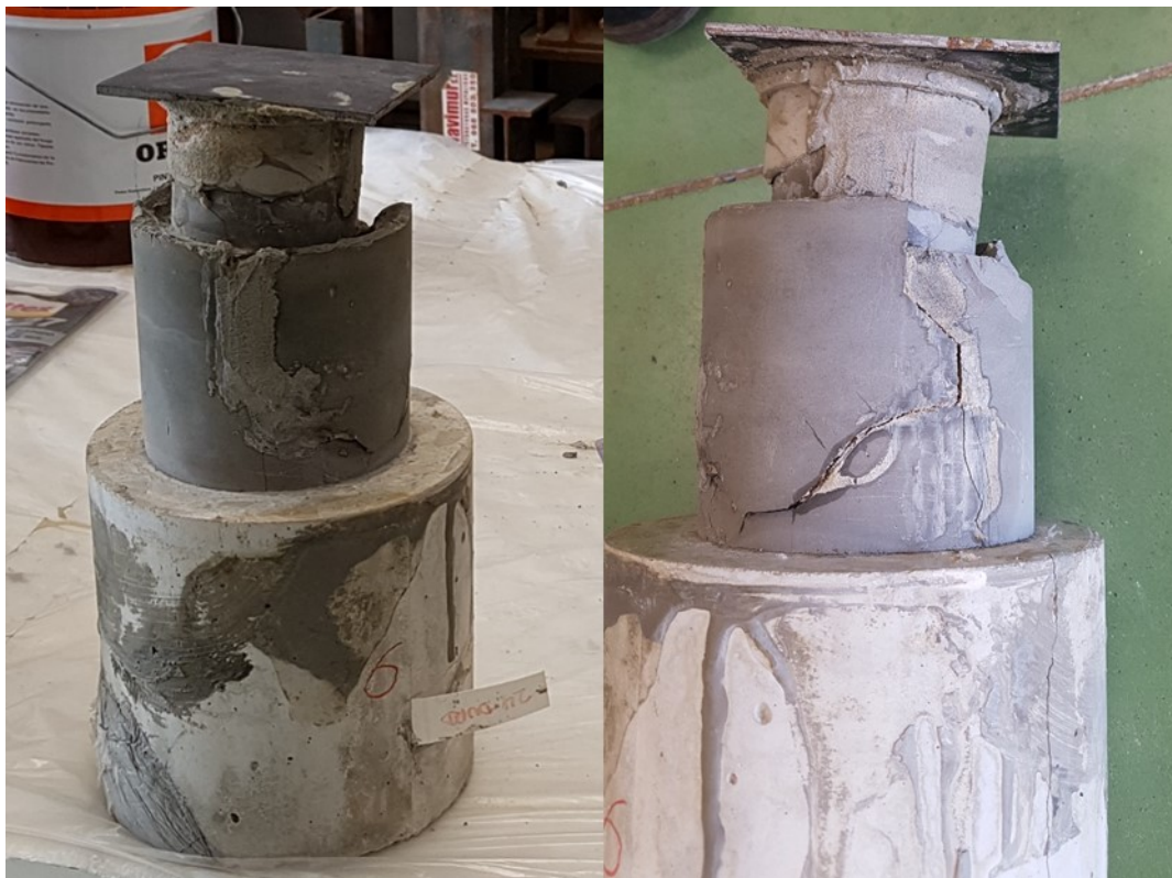
Figura 144. Fotografías de la probeta Cilíndrica 6 antes y después de la rotura. Fuente: Elaboración propia.
