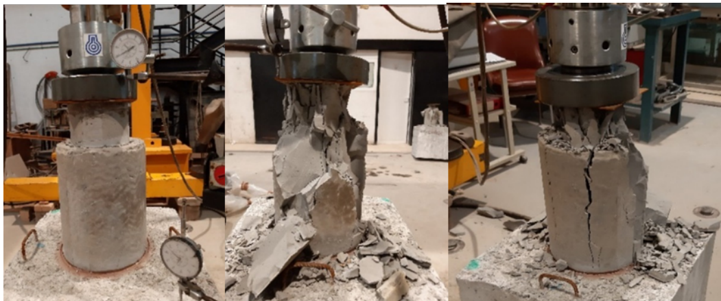
Figura 97. Fotografías de la probeta S10 antes y después de la rotura. Fuente: Elaboración propia.
