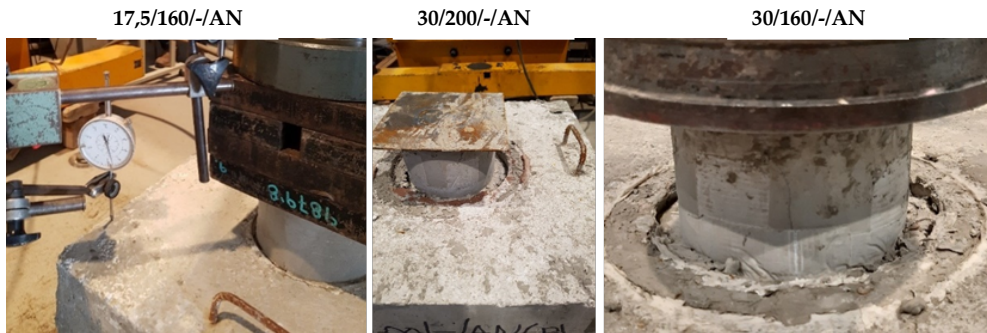
Figura 52. Probetas llevadas a rotura en pórtico que han desarrollado el descenso del micropilote en la zona de unión con la zapata. Fuente: Elaboración propia.
