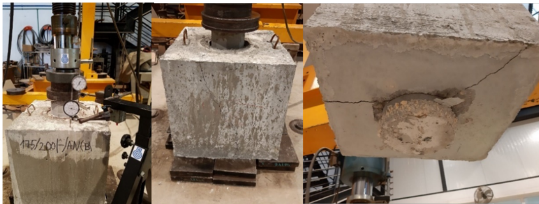
Figura 65. Fotografías de la probeta C4 antes y después de la rotura. Fuente: Elaboración propia.
