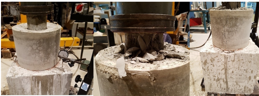
Figura 91. Fotografías de la probeta S7 antes y después de la rotura. Fuente: Elaboración propia.
