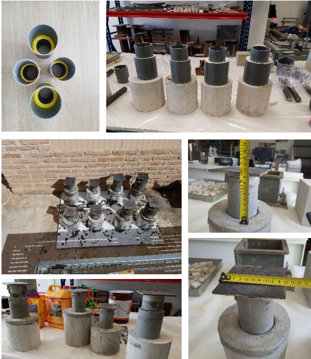
Figura 9. Preparación de las probetas a escala reducida. Fuente: Elaboración propia.
