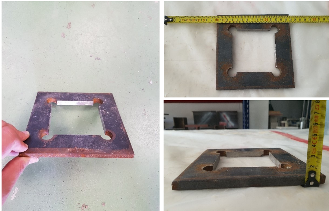
Figura 10. Placa de acero de apoyo perforada para la realización de los ensayos. Fuente: Elaboración propia.
