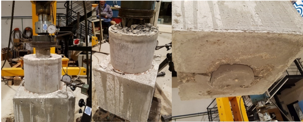
Figura 93. Fotografías de la probeta S8 antes y después de la rotura. Fuente: Elaboración propia.
