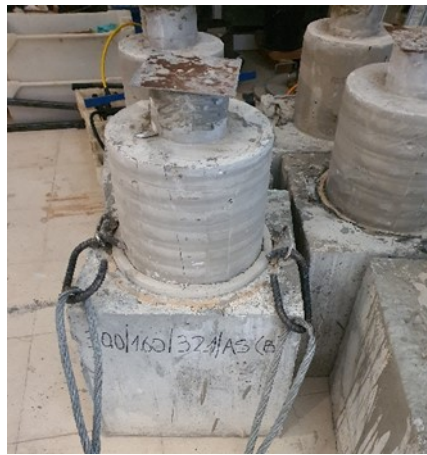
Figura 131. Fotografías de la probeta SA12 antes de la rotura. Fuente: Elaboración propia.
