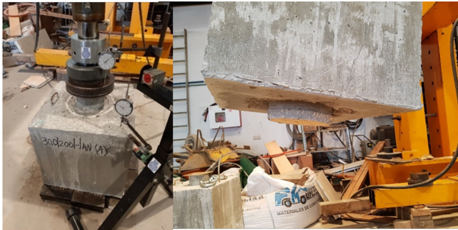
Figura 71. Fotografías de la probeta C7 antes y después de la rotura. Fuente: Elaboración propia.
