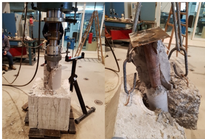
Figura 81. Fotografías de la probeta S2 antes y después de la rotura. Fuente: Elaboración propia.
