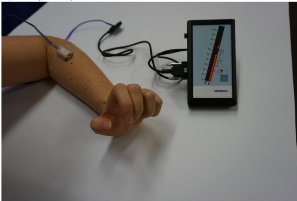
Figura 9. Sistema de sEGM con biofeedback (MyoBoy©) para uso doméstico. La actividad muscular se identifica mediante una señal luminosa, de intensidad escalable. Fuente: https://doi.org/10.3389/fnins.2018.00906 .
