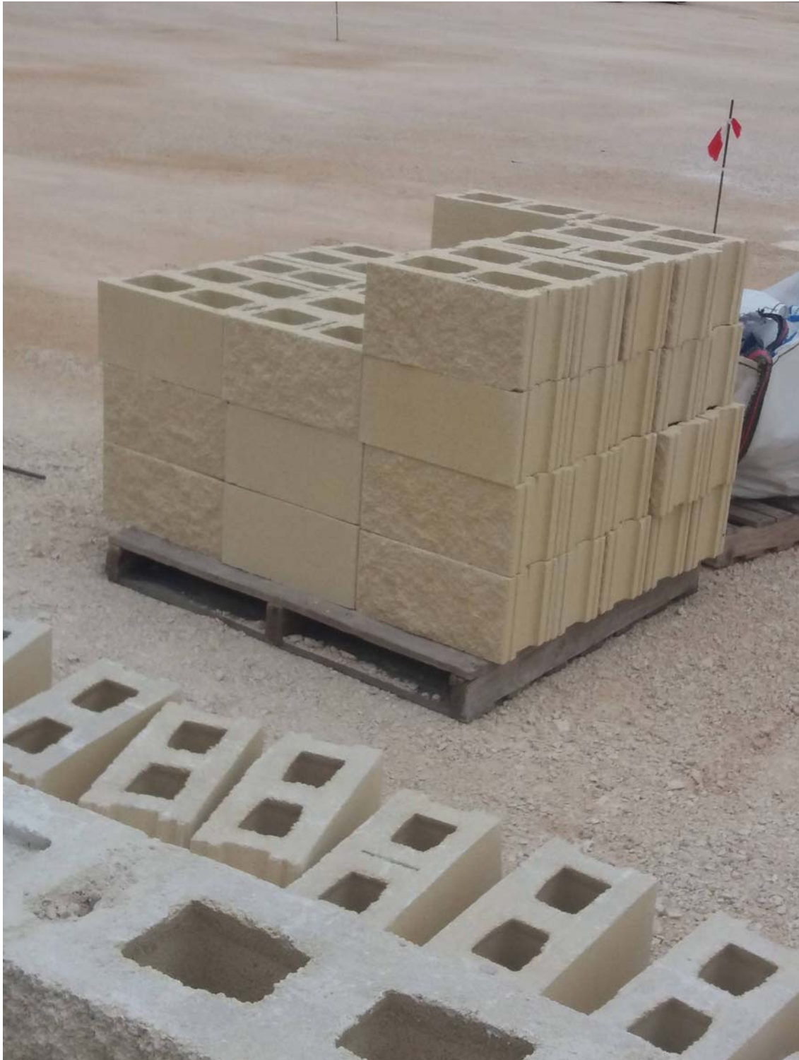
Bloques de hormigón vibrado con distintos acabados para una fábrica vista.
