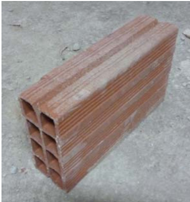
Ladrillos cerámicos de doble hueco (7 cm de espesor) y de triple hueco (11 cm de espesor).
