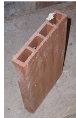
Ladrillos cerámicos de doble hueco (7 cm de espesor) y de triple hueco (11 cm de espesor).
