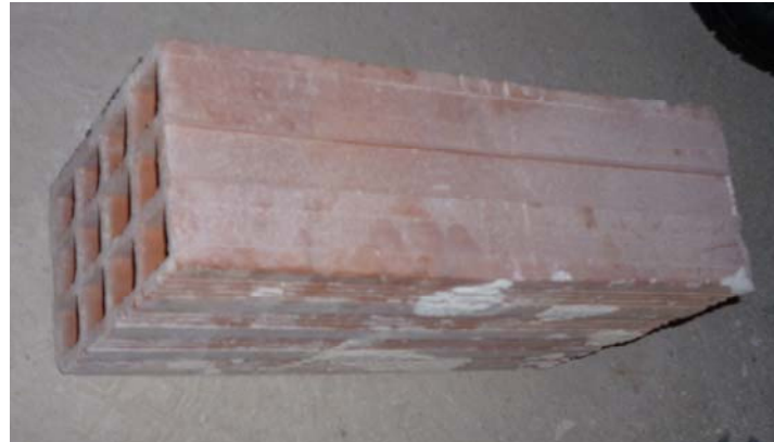
Ladrillos cerámicos de doble hueco (7 cm de espesor) y de triple hueco (11 cm de espesor).
