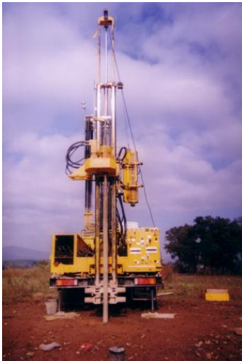
Ejecución de sondeos mecánicos con barrena helicoidal. Fuente: <www.sondgea.com> y <www.cpgeologics.com> [Consulta: 3 de febrero de 2012].
