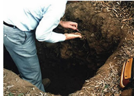
Penetrómetro de bolsillo. Fuente: <www.pinzuar.com> [Consulta: 3 de febrero de 2012]. Calicata y medición de resistencia del terreno con penetrómetro. Fuente: <conceptosdemineria.blogspot> [Consulta: 3 de febrero de 2012].
