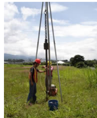
Prueba de penetración continua. Fuente: <www.myv-sg.com> [Consulta: 3 de febrero de 2012].
