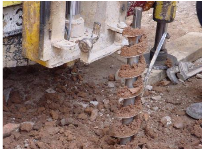
Ejecución de sondeos mecánicos con barrena helicoidal. Fuente: <www.sondgea.com> y <www.cpgeologics.com> [Consulta: 3 de febrero de 2012].
