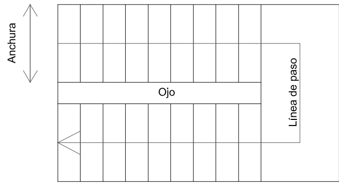
Elementos compositivos de una escalera. E = 1/100.
