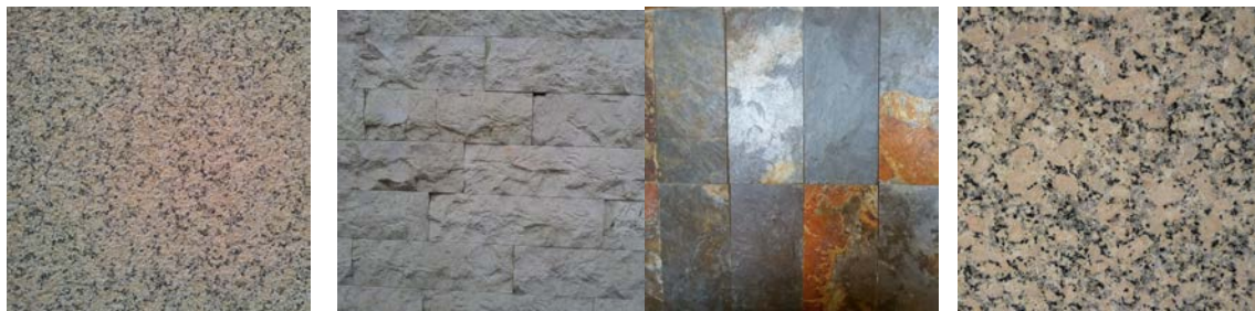
Pétreos naturales con acabado arenado, escafilado y pulido.
