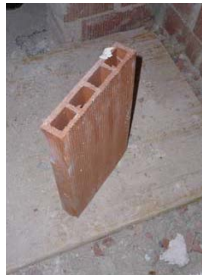
Trasdosado de una medianera entre edificios con tabique a panderete, realizado con piezas cerámicas de gran formato (rasillones).
