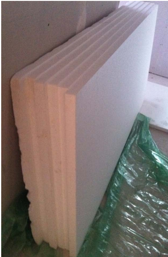
Placas de escayola convencionales y placas acústicas con fibras naturales en masa.
