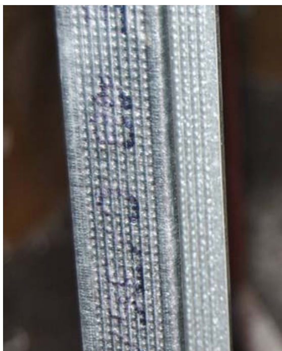
Textura del acero para favorecer el agarre de la tornillería.
