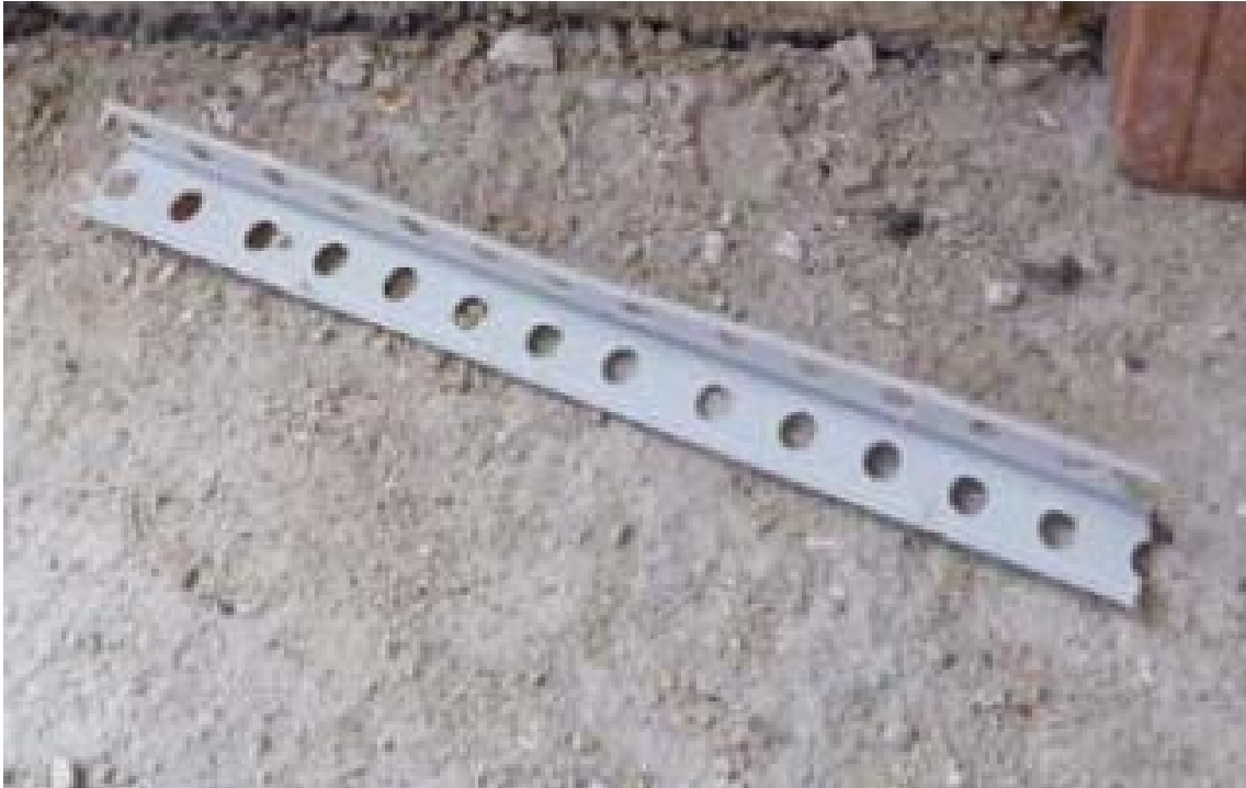
Perfil de PVC en L perforado para disposición en esquinas salientes.
