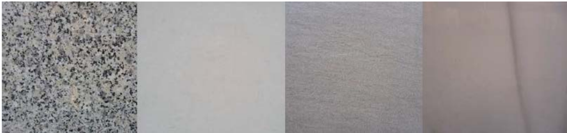
Ejemplos de pétreos utilizados en aplazados: granito, caliza, arenisca y mármol.
