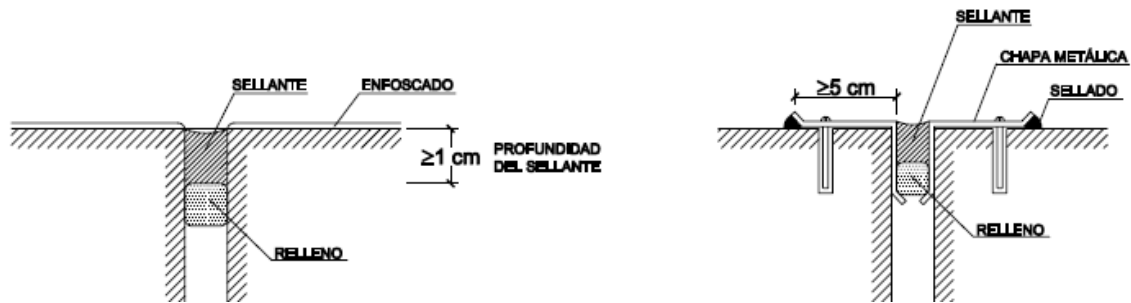
Solución de las juntas de dilatación de la fachada. Figura 2.6 del CTE DB HS, Salubridad, pág. HS1-15.
