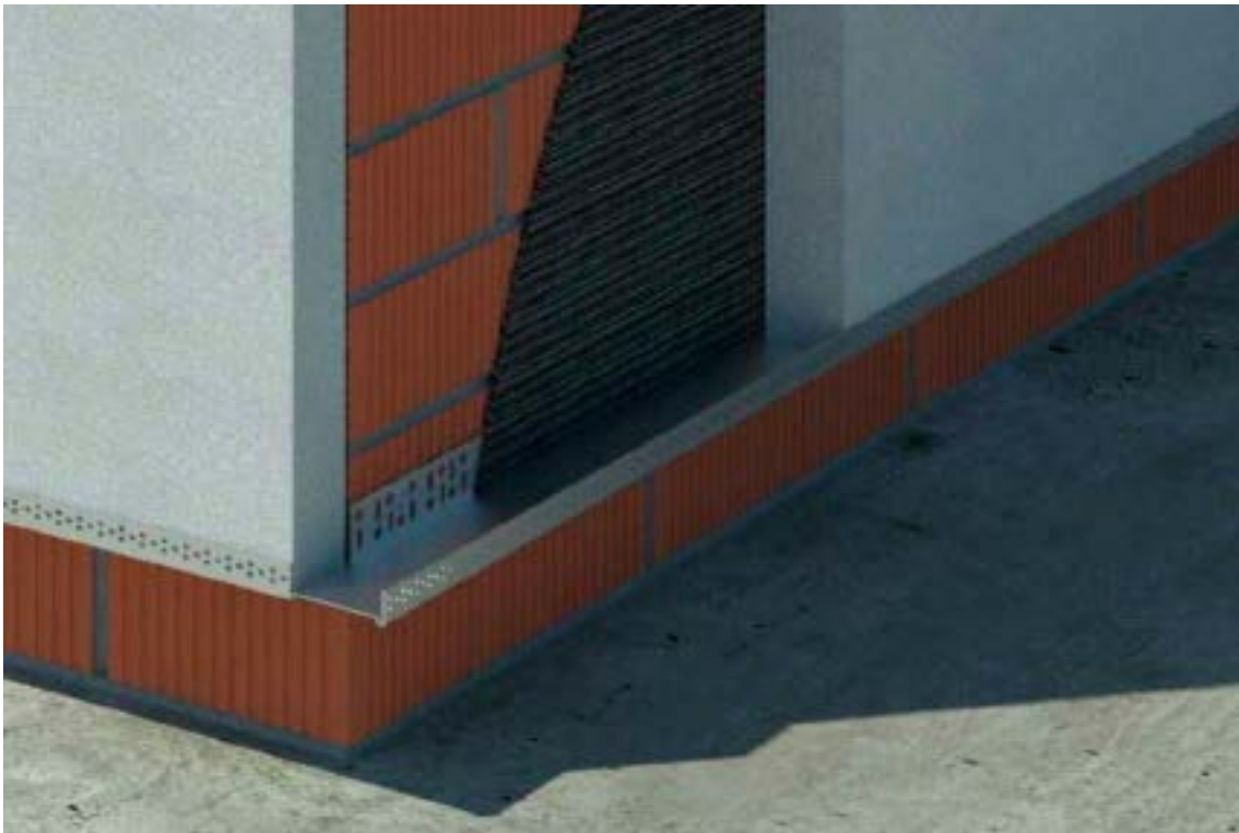
Perfil de arranque con goterón a 30 cm respecto de la rasante. Fuente: <www.grupopuma.com> [Consulta: 20 de junio de 2020].
