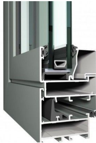
Ventanas de aluminio con y sin rotura de puente térmico. Fuente: < www.roturadepuentetermico.com > y < www.ventanaaluminios.com > [Consulta: 14 de septiembre de 2020].
