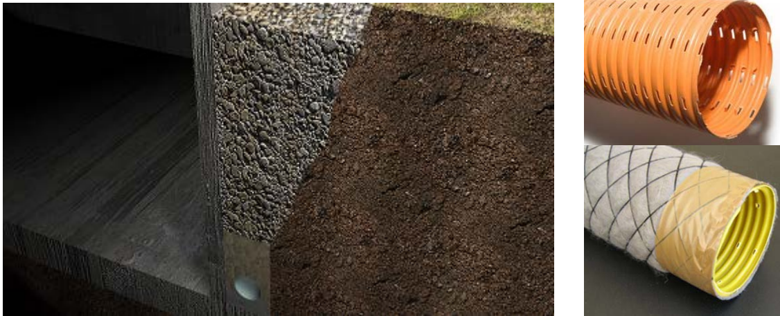
Drenaje de gravas en un muro de sótano. < www.generadordeprecios.info > [Consulta: 18 de febrero de 2012]. Tubo dren. < www.agomatica.es > [Consulta: 18 de febrero de 2012]. Tubo dren con geotextil incorporado. < www.projar.es > [Consulta: 18 de febrero de 2012].
