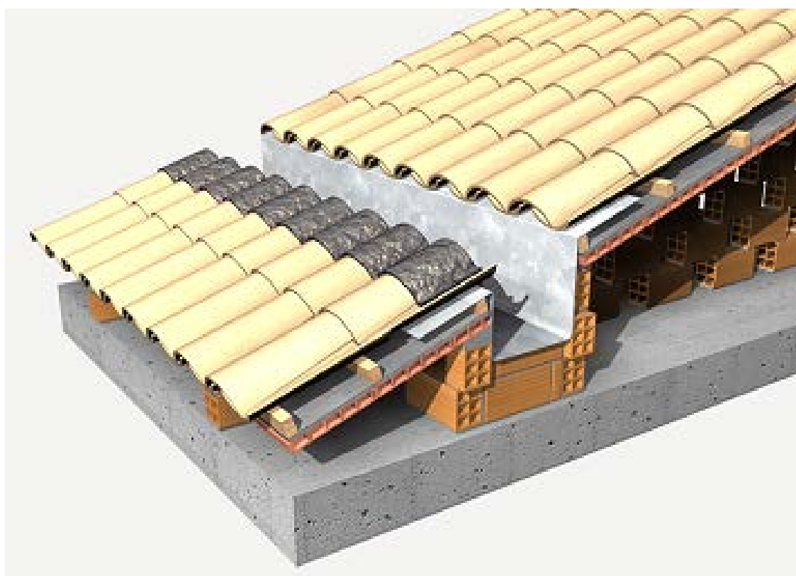
Cuñas de relleno de las canales bajo cumbre. Fuente: < www.generadordeprecios.info > [Consulta: 20 de mayo de 2018].
