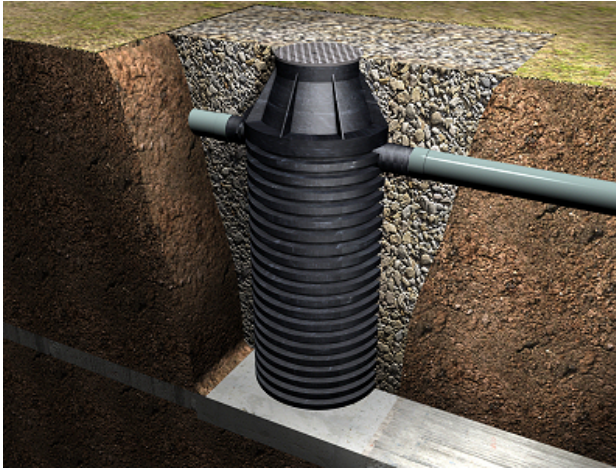
Pozo drenante de polietileno de alta densidad. Fuente: < www.generadordeprecios.info > [Consulta: 3 de febrero de 2012].
