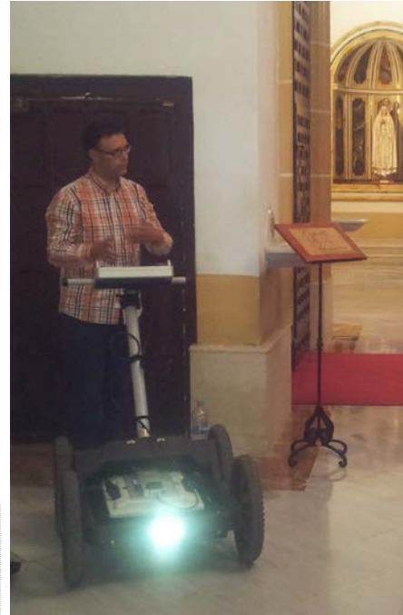
Uso del georradar para estudio de las cimentaciones de la iglesia del Monasterio de los Jerónimos, Guadalupe, Murcia.
