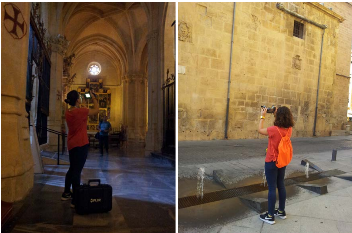
Uso de cámara termográfica para detección de humedades en la catedral de Oriuela.
