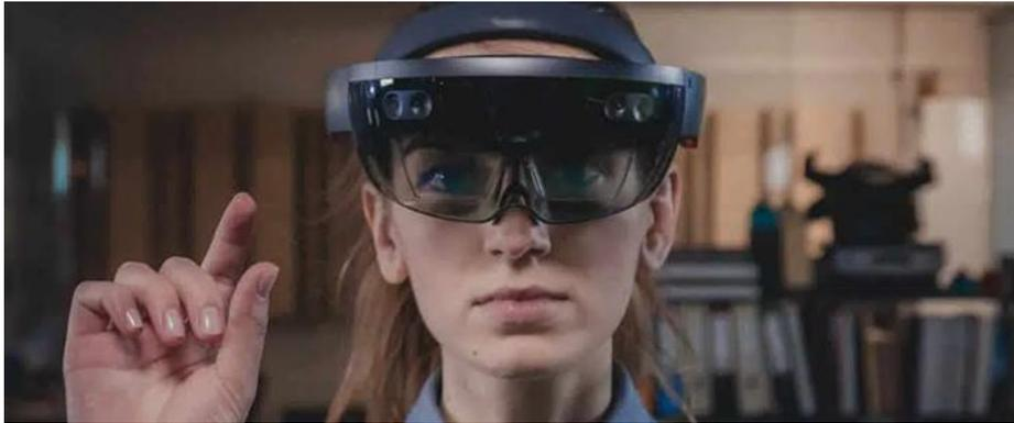
*Dispositivo de visualización que se ajusta directamente frente a uno o ambos ojos del usuario, mediante un soporte en la cabeza que permite que los contenidos digitales se superpongan a su campo visual (Aleger, s.f.)*
