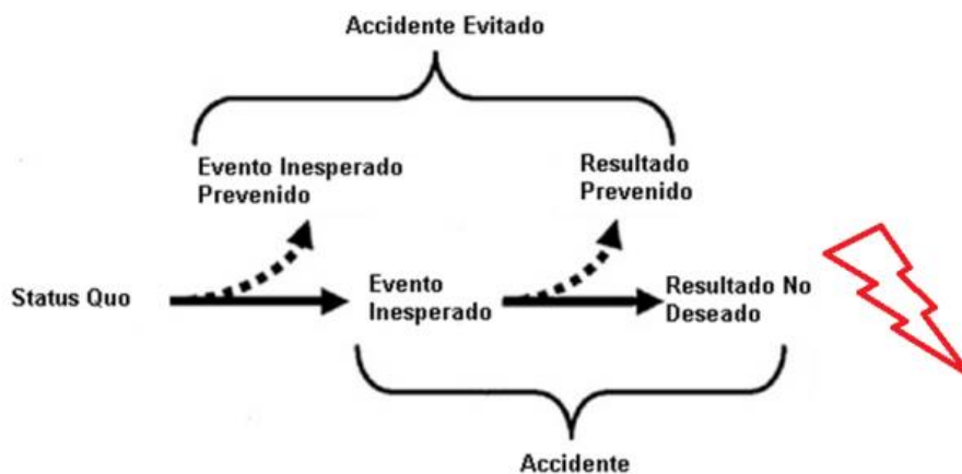
Figura 1. Partes constitutivas de un accidente. Traducido y adaptado de Hollnagel, E. Barriers and accident prevention . Aldershot, UK: Ashgate 5 .
