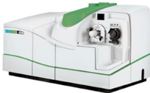
Figura 4.7. Espectrómetro de masas de plasma de acoplamiento inductivo (ICP-MS) Nexión 300D (Cortesía del SCAI).
