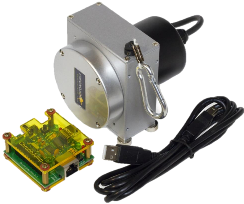
Figura 3. Transductor lineal de velocidad (chronojump Boscosystem) utilizado para medir la VMP de cada repetición.
