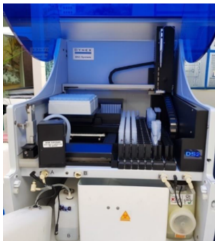
Figura 10: Equipo autoanalizador de microplacas modelo DS2® 2-Plate ELISA.
