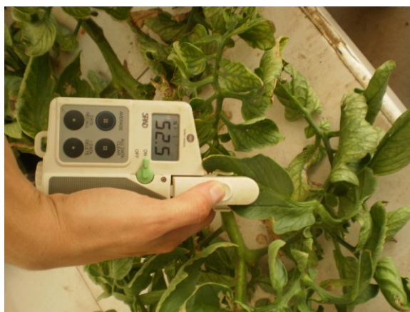
Figura III.18. Detalle de medida de clorofilas en campo con un clorofilómetro Minolta SPAD-502.
