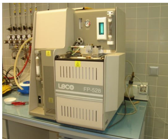
Figura III.24. Analizador LECO FP-528 (Leco Corporation, St. Joseph, MI. USA).
