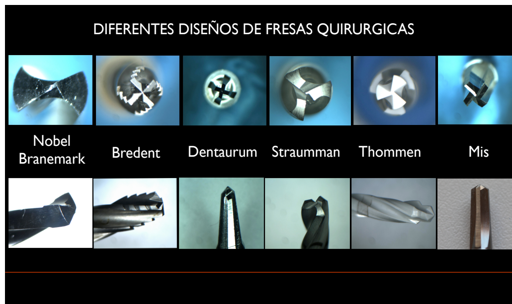
Fig. 10 Distintos diseños de las fresas quirúrgicas de 2, 3 y 4 hélices, con paredes planas, y cónicas, formas lineales y escalonadas.
