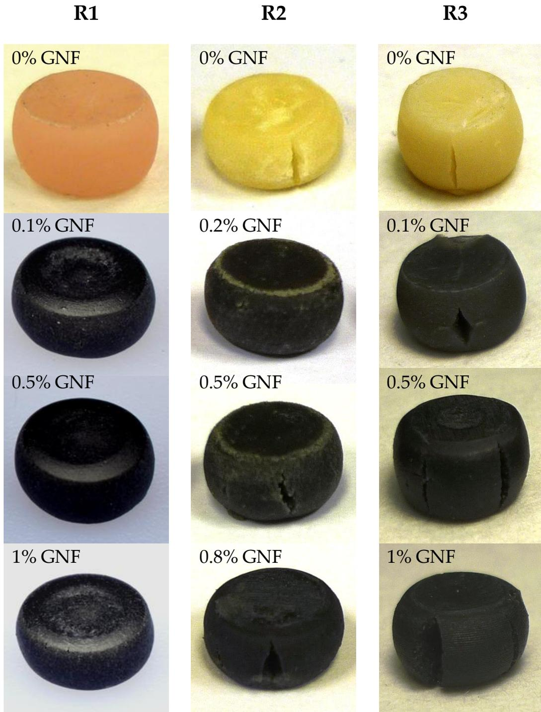
Figura 91. Aspecto de los pilares de materiales de resinas autopolimerizables con distintas cantidades de GNF tras realizar los ensayos de compresión.
