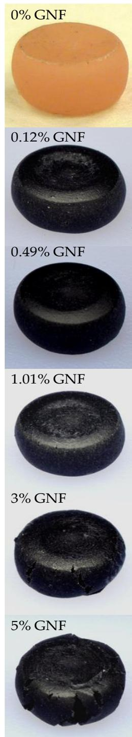
**Figura 56. Aspecto de los pilares de materiales de resina R1 sin y con distintas cantidades de GNF tras realizar los ensayos de compresión.**
