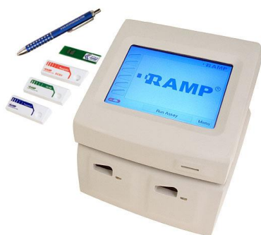
Figura I.16: Lector colorimétrico de tiras reactivas
