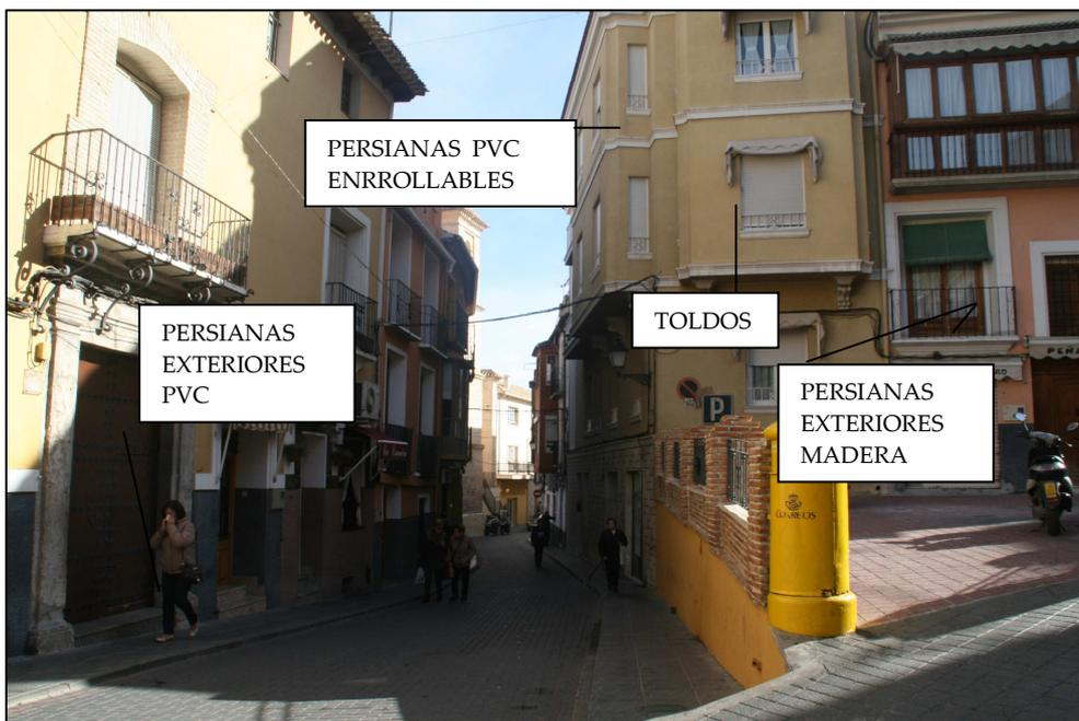
Figura 114. Protecciones solares. C/ Mayor (F.P.).
