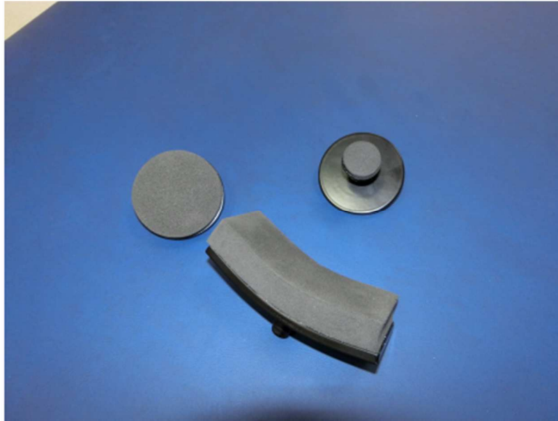
Figura 5.14. Adaptadores para el dinamómetro manual (Fuente propia).
