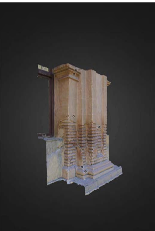
Figura 123 y figura 124. Respectivamente: Vista lateral y frontal. Modelo tridimensional generado por fotogrametría etiquetado con anotaciones históricas para facilitar su difusión social. Plataforma Sketchfab. Detalle interior del claustro del Monasterio de los Jerónimos, Guadalupe (Murcia). Fuente: Autor.
