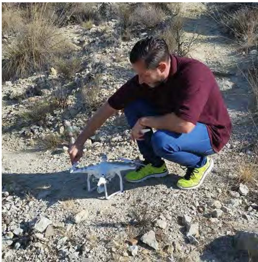
Figura 255. Puesta a punto del dron antes de comenzar el vuelo fotogramétrico. Fuente: Autor.
