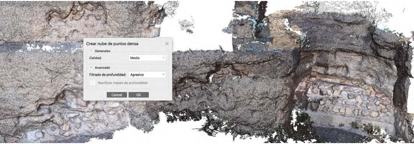
Figura 088 (superior). Ventana emergente en fase flujo de trabajo de nube de puntos densa dentro de Agisoft PhotoScan. Castillo de la Luz, Parque Regional Carrascoy y El Valle, Murcia. Fuente: Autor.
