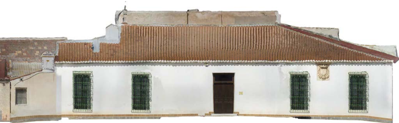
Figura 098. Alzado georreferenciado resultado del trabajo fotogramétrico. Tareas de levantamiento gráfico para la rehabilitación de la Alquería de Lo Marabú, Rojales (Alicante). Fuente: Autor.
