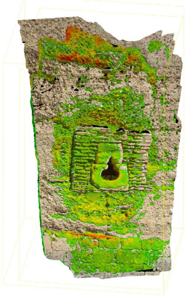
Figura 075. Comparativa de distorsión de mallas generadas por PhotoScan y Photomodeler. Resultado obtenido con CloudCompare v.2. Fuente: Autor.
