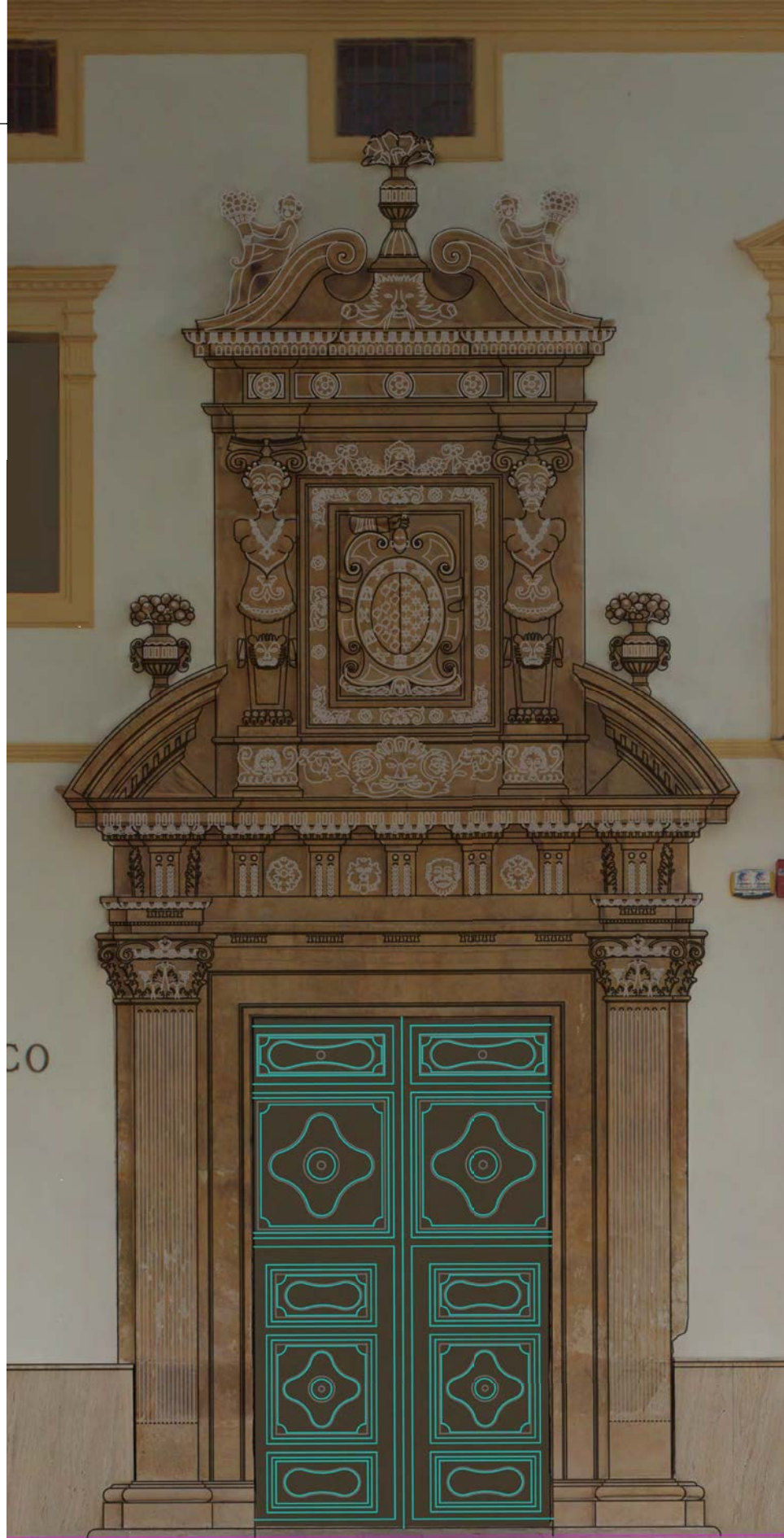
Figura 016. Solape entre ortofotografía y representación CAD de la puerta principal de acceso a Casa de los Salazar Rosso. Desde 1992 Museo Arqueológico de Lorca (Murcia). Fuente: Representación lineal Jerónimo Granados, ortofotografía realizada por el autor.
