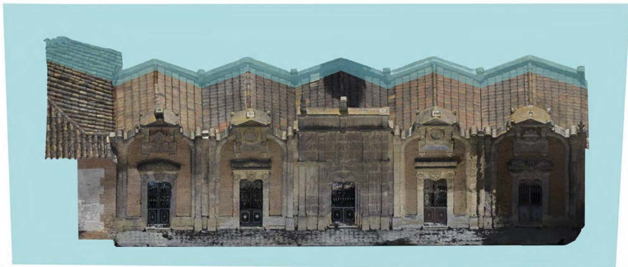
Figura 230. Perspectiva tridimensional con indicación de plano de corte longitudinal. Modelo fotogramétrico del conjunto de panteones estudiados en el Cementerio de San Clemente, Lorca (Murcia). Fuente: Autor.
