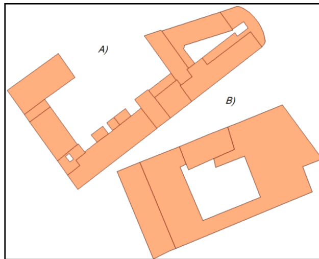
Figura 7.17: Edificios gravados por irregularidad en planta. A) Edificio con un índice de RC de 0.38 y modificador +0.05. B) Edificio con RC de 0.58 y modificador de +0.01. Fuente: Lantada.
