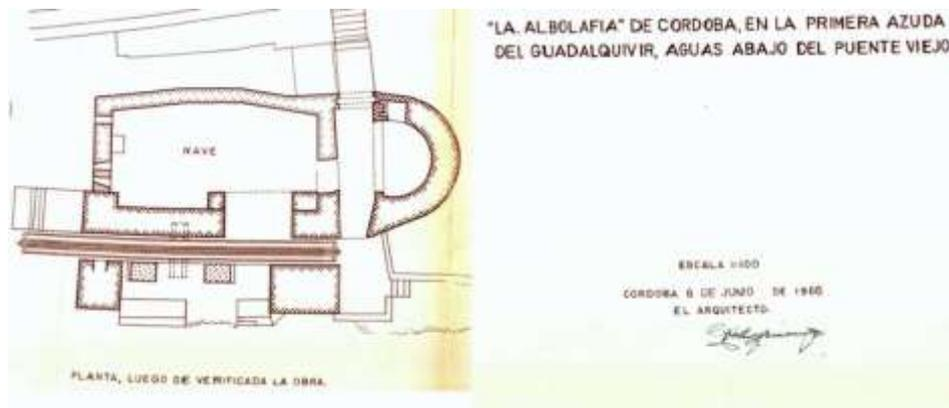
Fig. II.76. Plano de planta del Molino y noria de La Albolafia, restituyendo la rueda hidráulica. Del proyecto de Restauración de La rueda hidráulica del Molino de La Albolafia del arquitecto Félix Hernández. 1966. Archivo Municipal de Córdoba.
