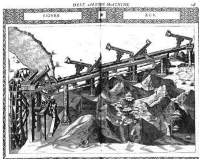
Ruedas hidráulicas verticales de corriente para la elevación de agua, de un recargado diseño..
