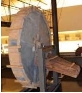
Fig. II.40. Tímpano. Noria de pie accionada por el hombre pedaleando o bien girando mediante manivela. Museo de la piel y el agua de Igualada. Barcelona.
