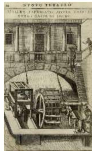
Ruedas hidráulicas verticales de corriente para la extracción de agua y combinadas con otras ruedas dentadas aplicadas a otros usos.
