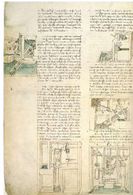
Ruedas hidráulicas verticales para elevación de agua y en combinación con otros ingenios como el tornillo de Arquímedes para configurar máquinas más complejas.
