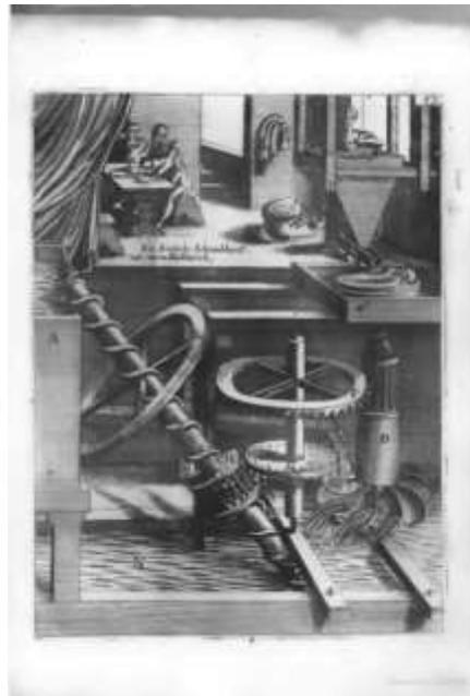
Ruedas hidráulicas verticales de corriente para la extracción de agua y combinadas con otras ruedas dentadas o de cangilones en molinos. Tornillo de Arquímedes.
