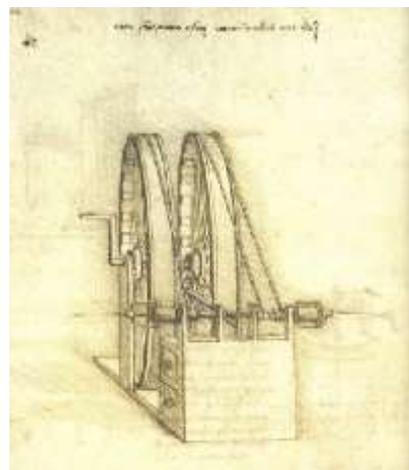
Código I. Estudios sobre ruedas hidráulicas: Golpe del agua sobre la pala y los cangilones de la rueda del molino. Cuanto más delgado sea el eje de las ruedas, más fácil será el movimiento. Movimiento de redas mediante manivela.
