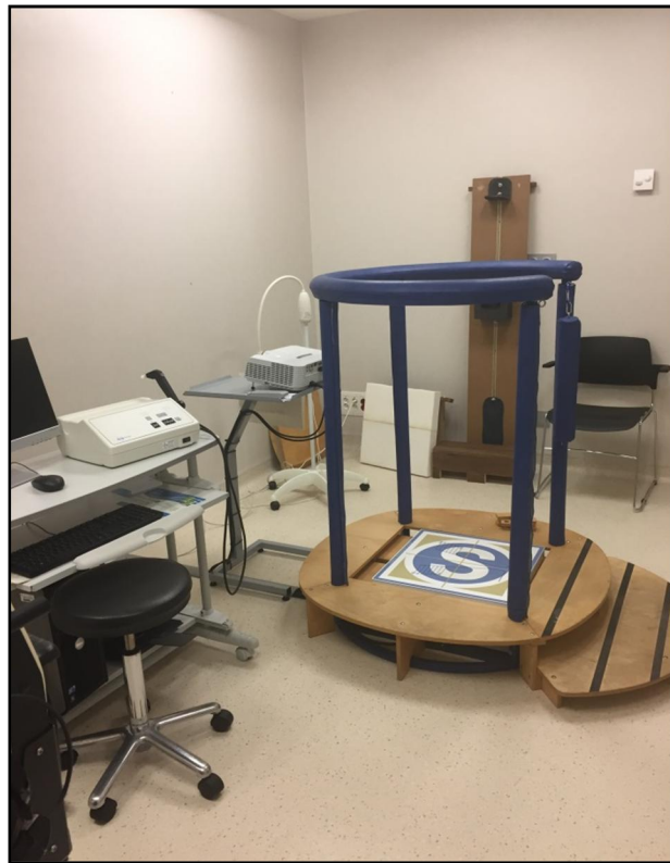
Fig. VI.1. Foto del posturógrafo SPS® Synapsys
