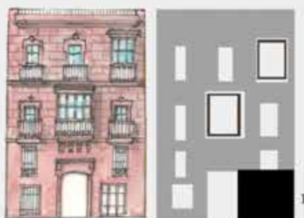
MAL ESTADO (Sólo se conserva fachada) 1 La planta baja muy deteriorada
