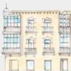
BUEN ESTADO 1 Planta baja modificada levemente (falta rejeria)
