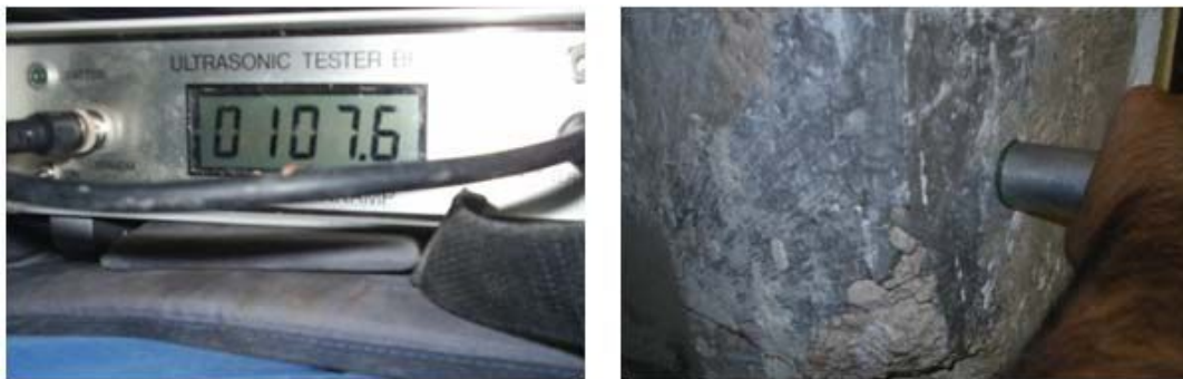
Figura 3. Ultrasonic Tester (izquierda). Análisis “in situ” mediante Ultrasonidos (derecha). (Fuente: Los autores).
