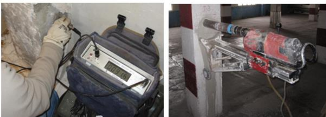
Figura 3: Otros dos detalles del proceso de análisis de ultrasonidos (izquierda) y momento de extracción de una probeta testigo (derecha).
