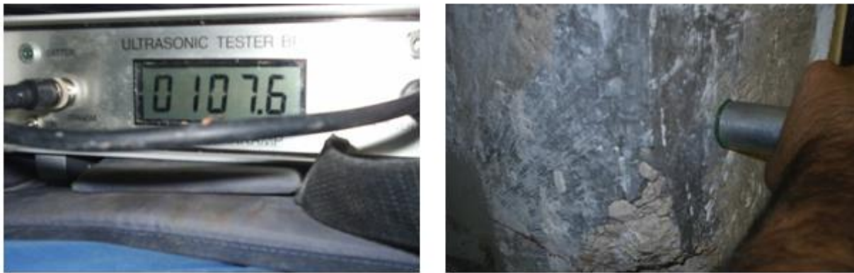
Figura 1: Ultrasonic Tester (izquierda). Análisis “in situ” mediante Ultrasonidos (derecha).
