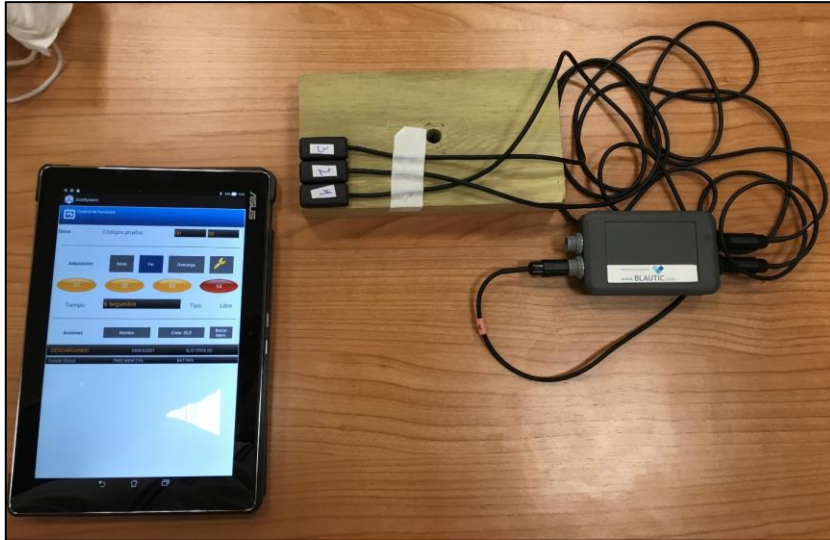
Figura 44. Verificación del adecuada calibración y funcionamiento del sistema de acelerometría. Elaboración propia.
