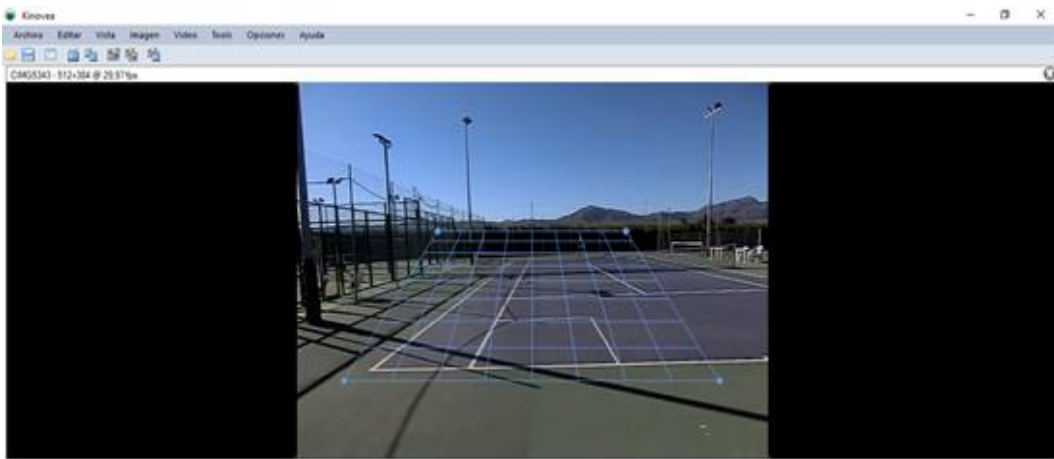
Figura 5.8. Software empleado para la digitalización del bote de la pelota en la pista
