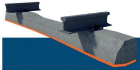
Figura 0.8. Suela bajo traviesa. Fuente: (73)
