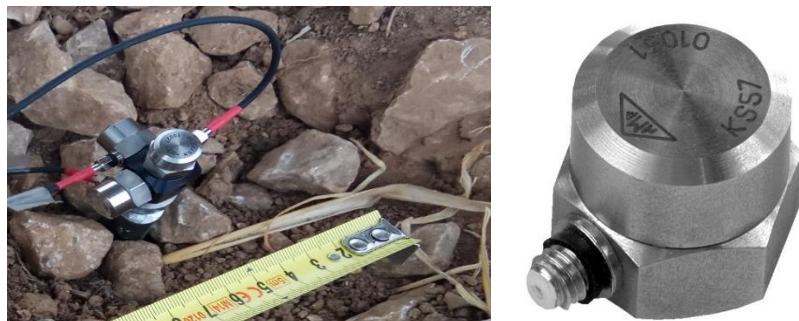
Figura 0.5 Sensores montados en base triaxial (izq) y aislado (dcha). Fuente: Elaboración propia (izq) y MMF (dcha.).
