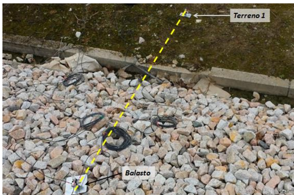
Figura 0.6 Ubicación de 2 puntos de medición: Balasto y Terreno 1. Fuente: Elaboración propia
