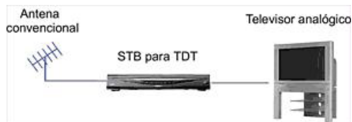
Figura 9. Esquema de recepción de TDT para un Televisor convencional.
