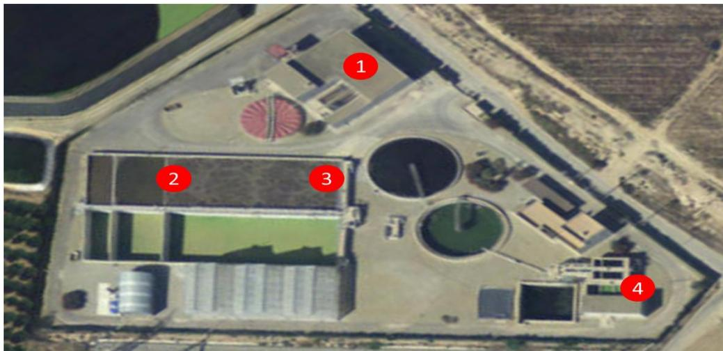
Figura 30. Puntos de recogida en la EDAR de Roldán. La numeración representa 1: Influyente; 2: Reactor biológico zona aerobia inicial; 3: Reactor biológico zona aerobia final; 4: Efluente.
