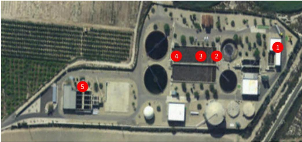
Figura 29. Puntos de recogida en la EDAR de Molina. La numeración representa 1: Influyente; 2: Reactor biológico zona anóxica; 3: Reactor biológico zona aerobia inicial; 4: Reactor biológico zona aerobia final; 5: Efluente.
