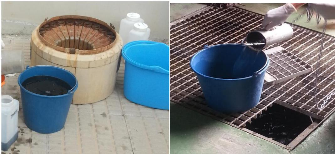
Figura 9. Tomamuestras automático de 24 horas en el influente de la planta y muestreo puntual de las muestras en el efluente.
