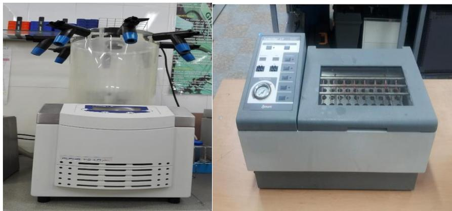
Figura 14. Liofilizador y evaporador de nitrógeno utilizados durante el tratamiento de las muestras.
