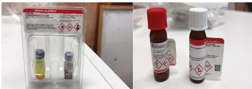
Figura 11. Patrones internos de la carbamazepina, ibuprofeno y diclofenaco para determinar la pérdida debido al proceso de extracción.
