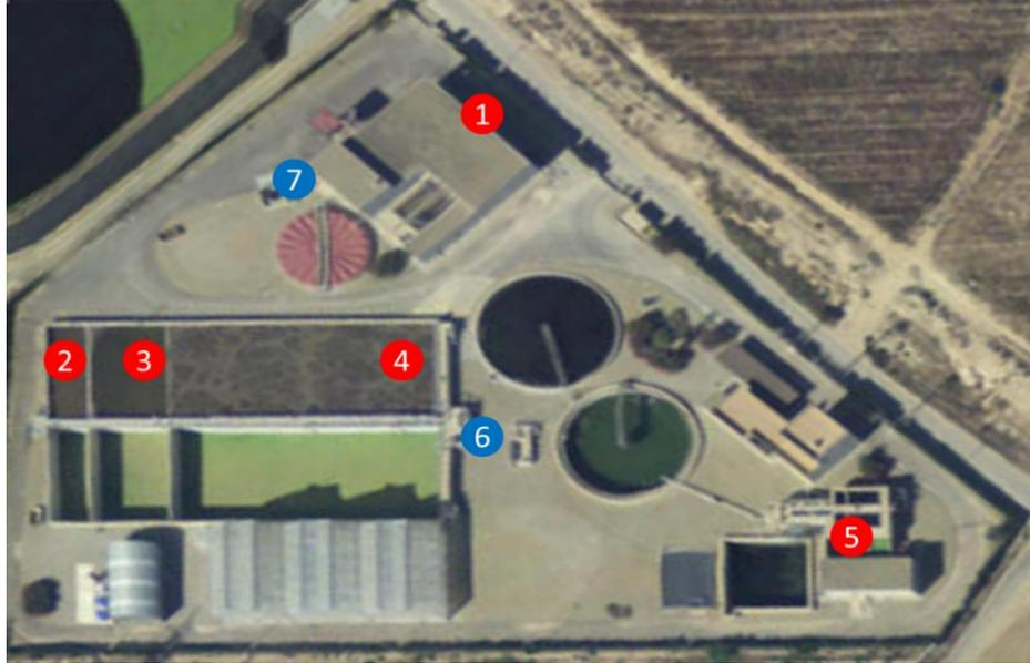
Figura 37. Puntos de recogida en la EDAR de Roldán. La numeración representa 1: Influyente; 2: Reactor biológico fase anóxica (R.B.1); 3: Reactor biológico fase anaeróbico (R.B.2); 4: Reactor biológico fase aeróbico (R.B.3); 5: Efluente; 6: Lodo recirculado; 7: Lodo deshidratado/seco.
