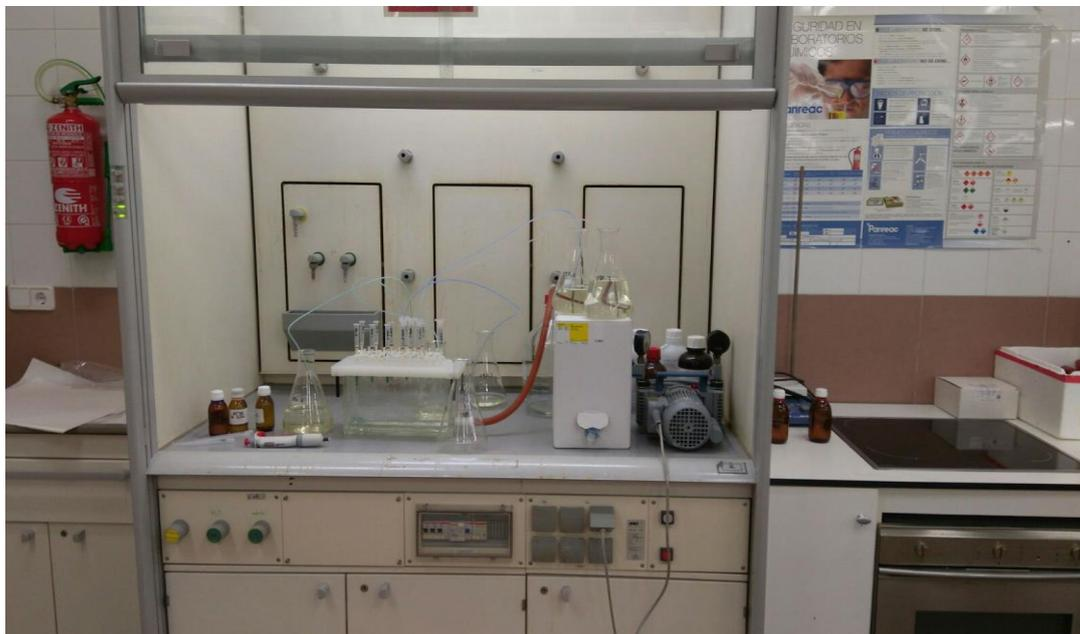
Figura 16. Etapa de extracción en fase sólida de las muestras a través de los cartuchos con la bomba de vacío.
