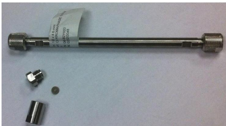
Figura 18. Columna de HPLC utilizada para el análisis de las muestras.
