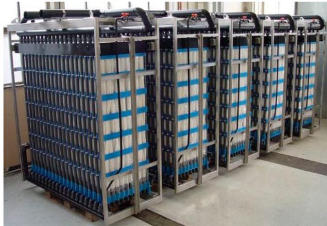
Figura 6. Instalación de casetes de membranas de ultrafiltración.
