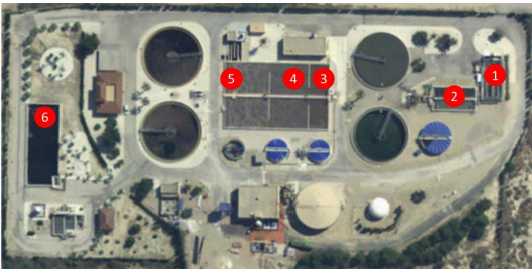
Figura 31. Puntos de recogida en la EDAR de Alcantarilla. La numeración representa 1: Desarenador-desengrasador; 2: Reactor biológico primario; 3: Reactor biológico zona anóxica; 4: Reactor biológico zona aerobia inicial; 5: Reactor biológico zona aerobia final; 6: Tanque de laminación.
