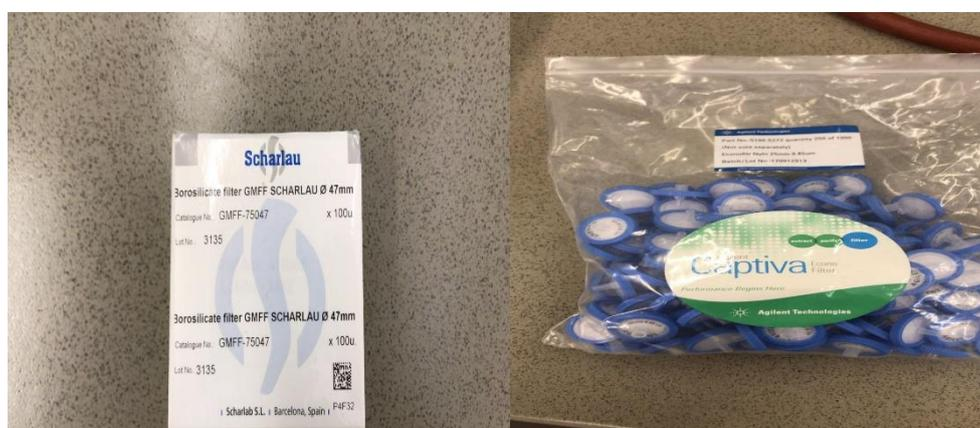
Figura 12. Filtros utilizados para la retención de las partículas que obturarían el proceso de extracción en fase sólida.
