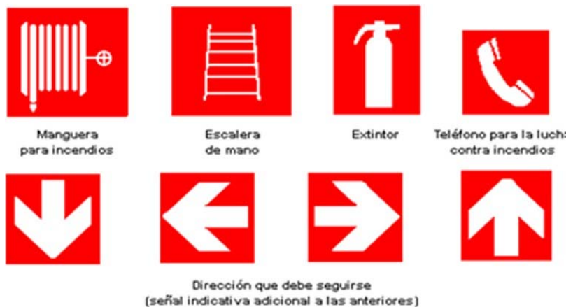
Figura 33. Señalización contra incendios
