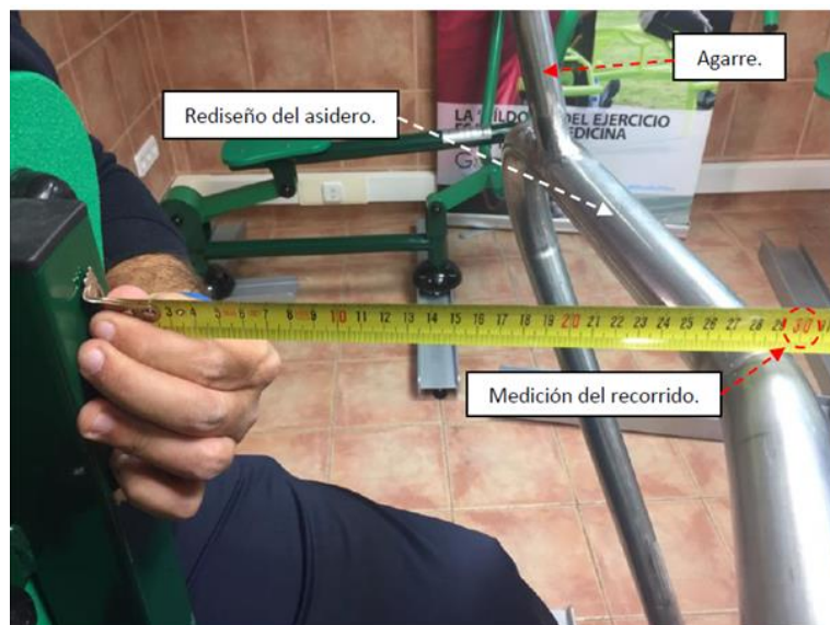
Figura 43. Modificación ángulo del asidero en el remo.
