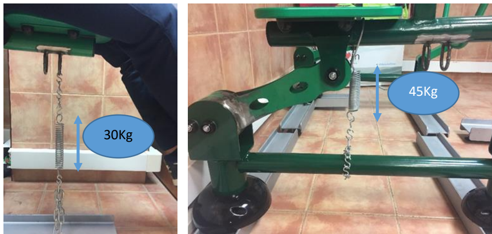
Figura 48. Implemento de sobrecarga a través de un muelle resistido.
