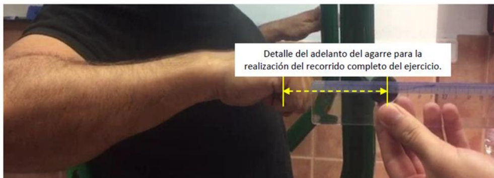
Figura 34. Detalle del adelanto en el asidero nuevo de PHS.
